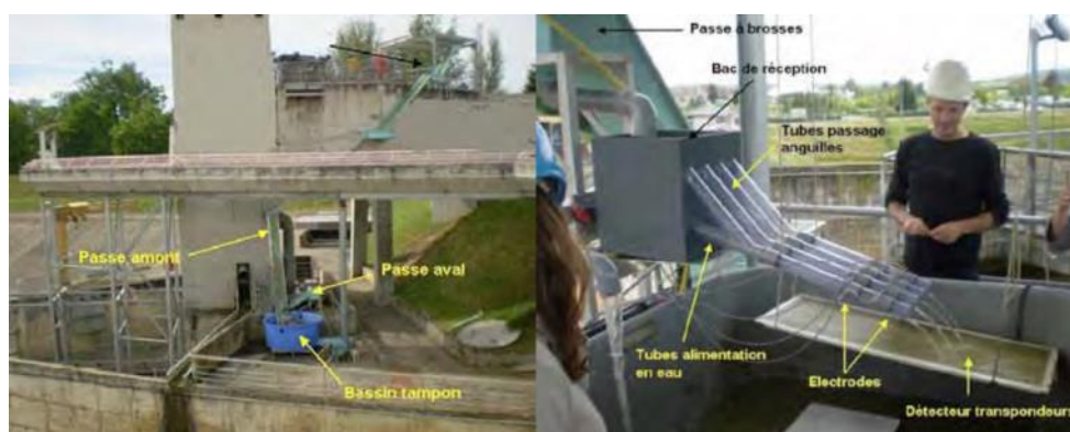
Figuur 17 Palinggoot en bijhorende 'resistivity counter' aan de Golfech waterkrachtcentrale aan de Garonne (FR).
