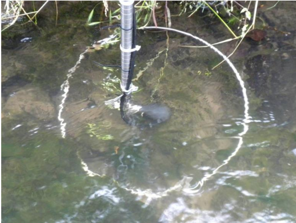
Figuur 74 Metalen ring met diameter van 40 cm waarbinnen in elk meetpunt de stroomsnelheid, waterdiepte en ingebedheid van het substraat wordt geschat.
