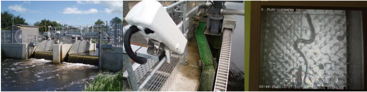
Figuur 22 Glasaalmonitoring met behulp van video-observatie t.h.v. het Greylake sluizencomplex (Somerset, VK) uitgevoerd door medewerkers van de Environment Agency.
