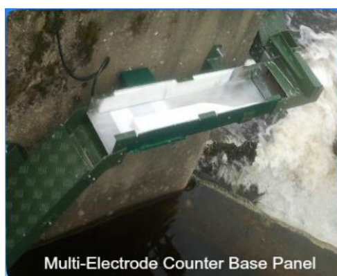
Figuur 18 Veldopstelling van de MEEC aan het uiteinde van een palinggoot.
