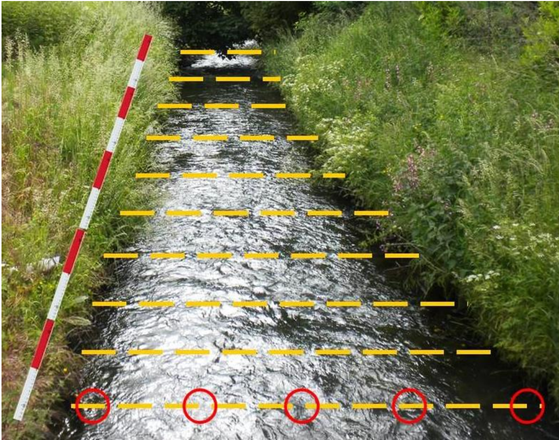
Figuur 73 Tien trajecten van drie of vijf meetpunten (afhankelijk van de breedte van de waterloop) worden gelijkmatig verdeeld over de lengte van de riffle.
