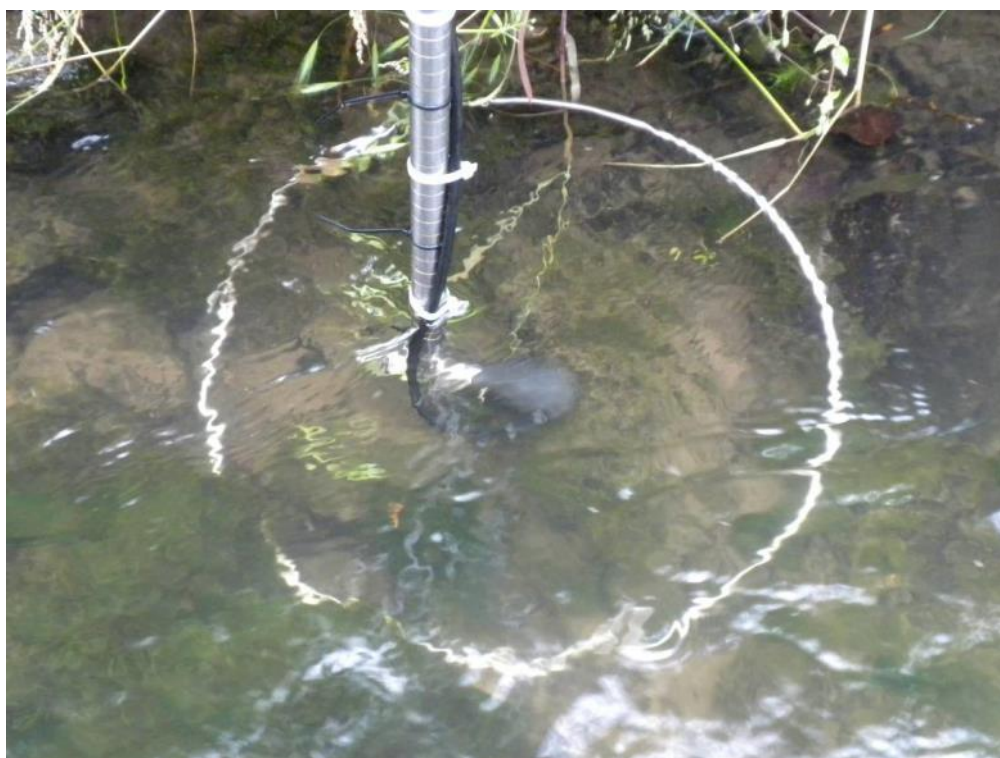
Figuur 63 Metalen ring met diameter van 40 cm waarbinnen in elk meetpunt de stroomsnelheid, waterdiepte en ingebedheid van het substraat worden ingeschat.
