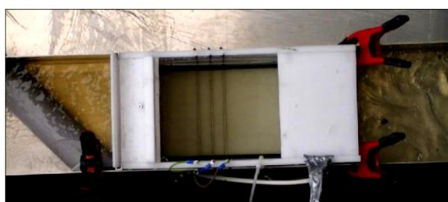
Figuur 19 De aangepaste Logie resistivity fish counter ontwikkeld door VisAdvies BV.
