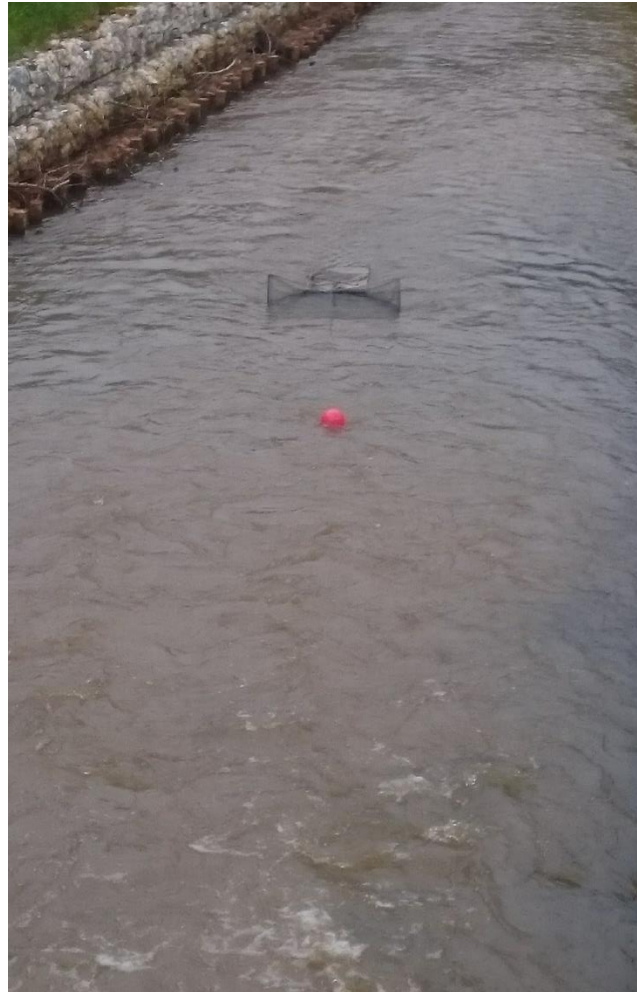
Figuur 85 Een fijnmazige fuik wordt achter de riffle geplaatst in de overgang tussen riffle en pool, en bevestigd met een anker.
