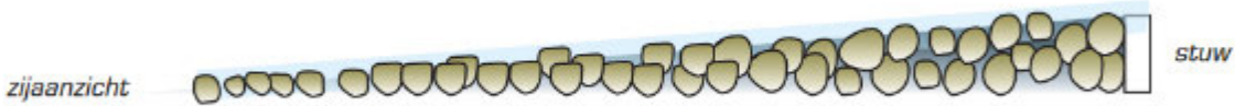
Afbeelding: Voorbeeld stuw met steenbestorting (bron: Vismigratie, een handboek voor herstel in Vlaanderen en Nederland, ANIMAL 2000)
