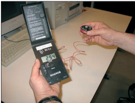
Meting van de verlichtingssterkte aan de hand van een luxmeter
