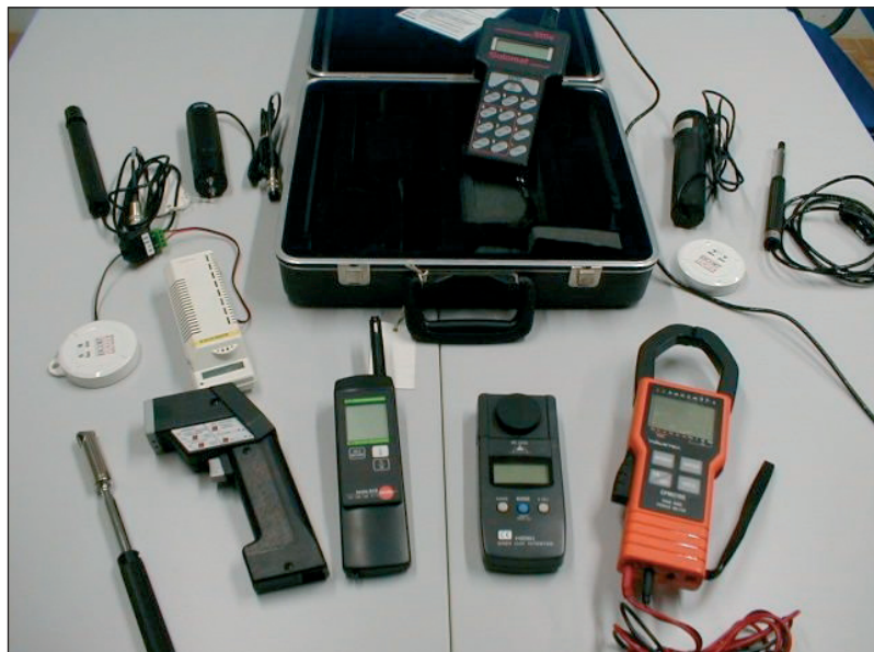
Figuur 16: meetkoffer en gespecialiseerde meetapparatuur gebruikt door een energieadviseur
