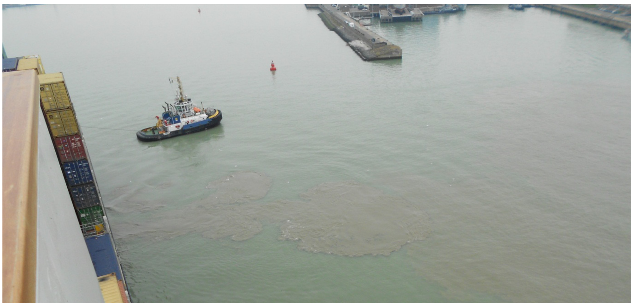
Figuur 8 – Ontwikkeling van een slibwolk tijdens een scheepsmanoeuvre met behulp van een sleeptboot(Dujardin et al, 2014)
