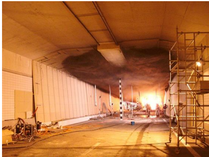
Figuur 3-12: Backlayering tijdens een full-scale testbrand in een verkeerstunnel (brandvermogen 20MW, ventilatiesnelheid 1,5-1,7 m/s).
