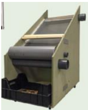
Figuur 3: mechanische keverscheider (Inagro, 2020)
