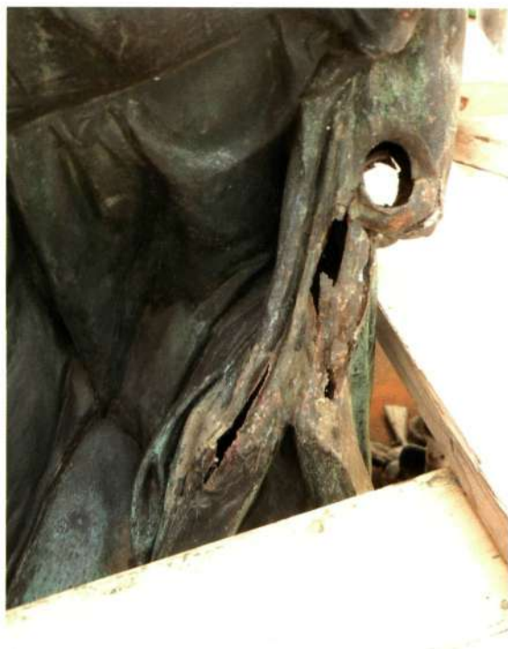
▲ Schade aan de hand die de drietand droeg (foto auteur)
