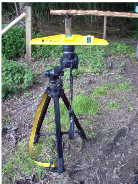
Figuur 21: Waterpas opstelling van het fototoestel op statief
