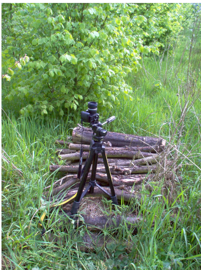
Figuur 20: Voorbeeldpositie van de opstelling tot het nemen van de digitale foto van de lichtinval boven een nestkoepel
