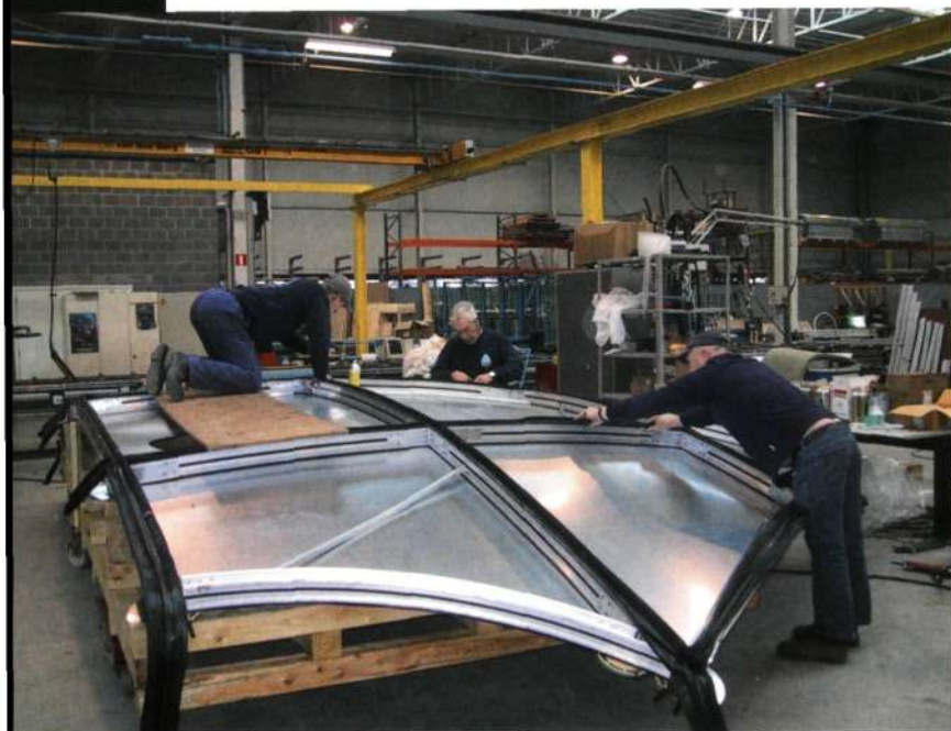
▲ Vervaardiging van de geprefabriceerde boldriehoek in atelier (foto Origin)
