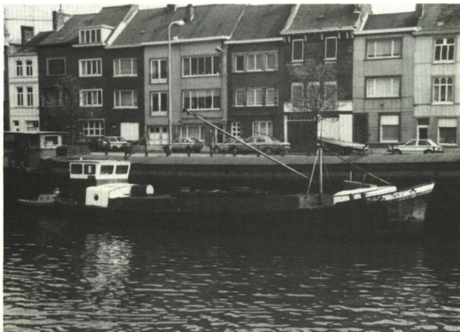
De 'Josée', een klipper van 1906, zoals de auteur haar ontdekte in Gent. Het oude, ranke zeilschip is onmiddellijk — mits wat oefening — herkenbaar. Afmetingen 4,40 bij 18,50 m. Het scheepje was gedurende jaren een mazoutbevoorradder, eerst rond Boom, dan in Gent. De Zeekadetten verbouwen het momenteel tot motorschip. Bemerkt de typische klipperkop.
