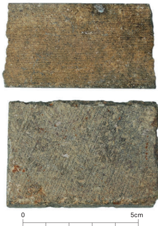
FIG. 2.5 Tongeren: O.L.V.-basiliek: zaagsporen op de onderkant van tegels in opus sectile in Trier diabaase (?).
