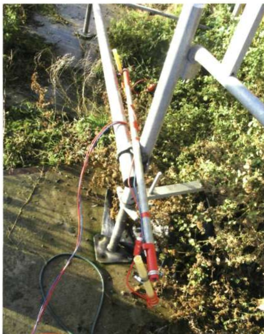
De meetelektroden gemonteerd met een vaste tussenafstand (foto Ingenieursbureau Norbert Provoost bvba)
