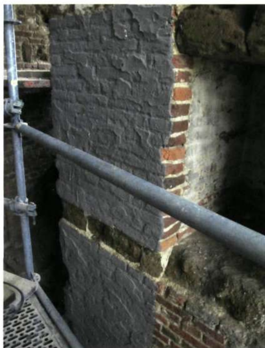
Testzone voor het aanbrengen (links) en verwijderen van de beschermende lagen (rechts) (foto L. Van Dijk)
