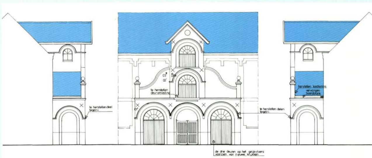
Het voormalig inkomportaal. Bestaande toestand met aanduiding van de herstellingen (eigen tekening)
