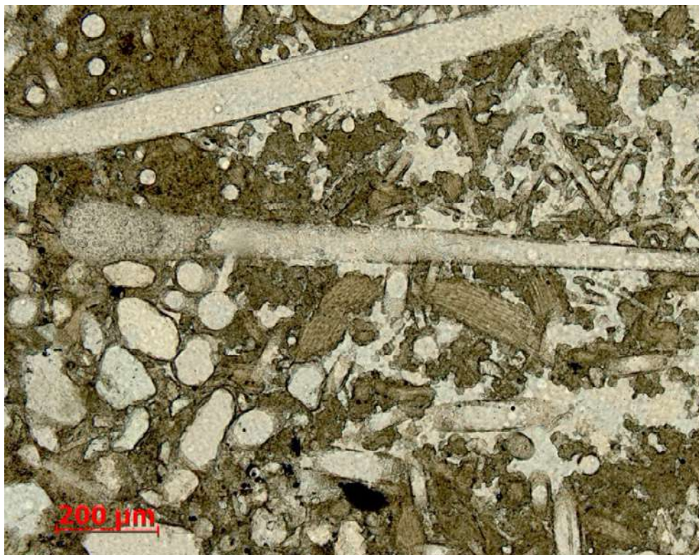
FIG. 112. Veldsteen. Microscopische opname van een slijpplaatje.
