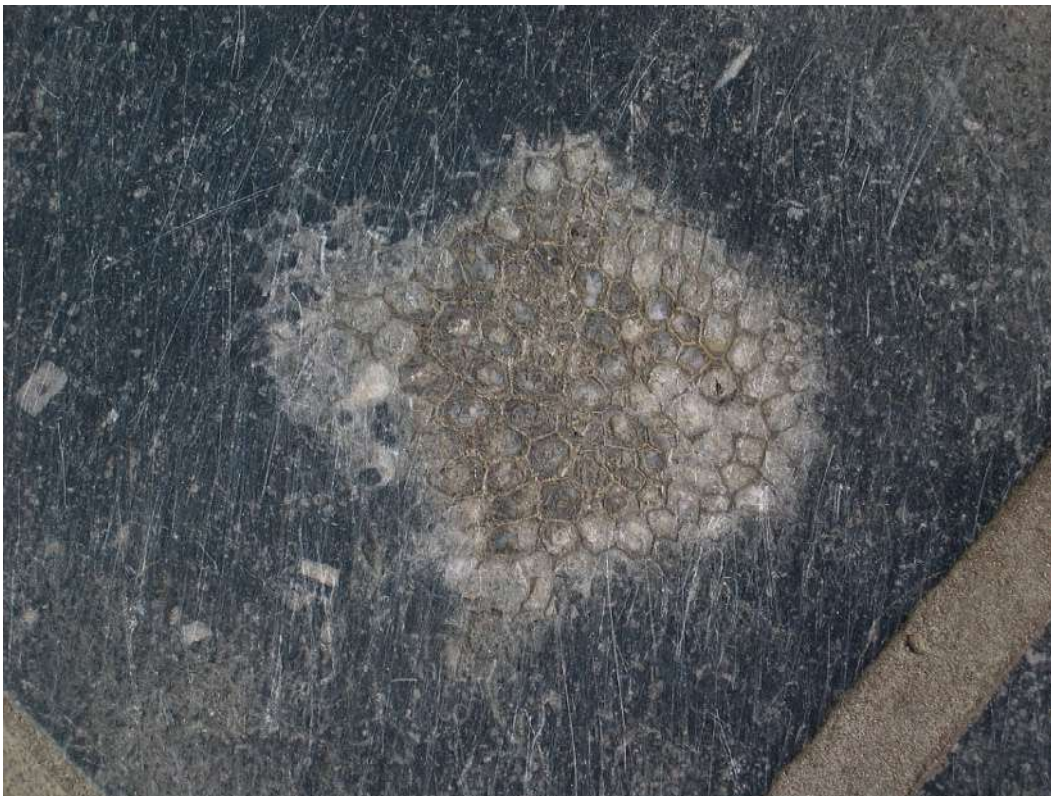
FIG. 59: Koraalkonie ( Michelinia favosa ) in door schoenen gladgeschuurde of gepolijste Petit Granit (traptrede).
