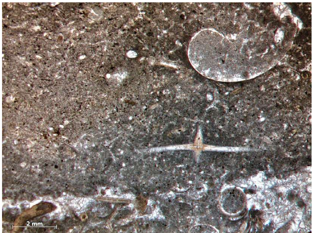
FIG. 108. Doorsnede van een sponsnaald. Microscopische opname van een slijpplaatje van het Rode marmer van Baelen.
