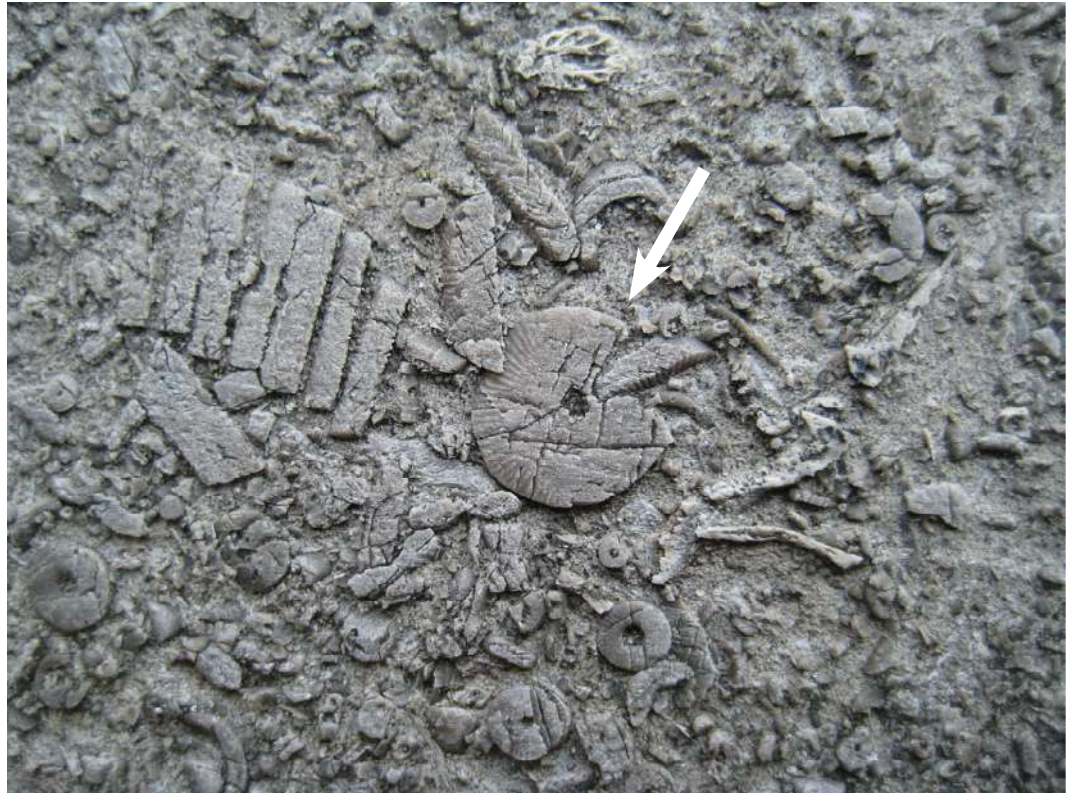
FIG. 60: Macroscopisch detail van het verweerde oppervlak van Petit Granit met diverse doorsneden van stengellidjes van crinoiden.
