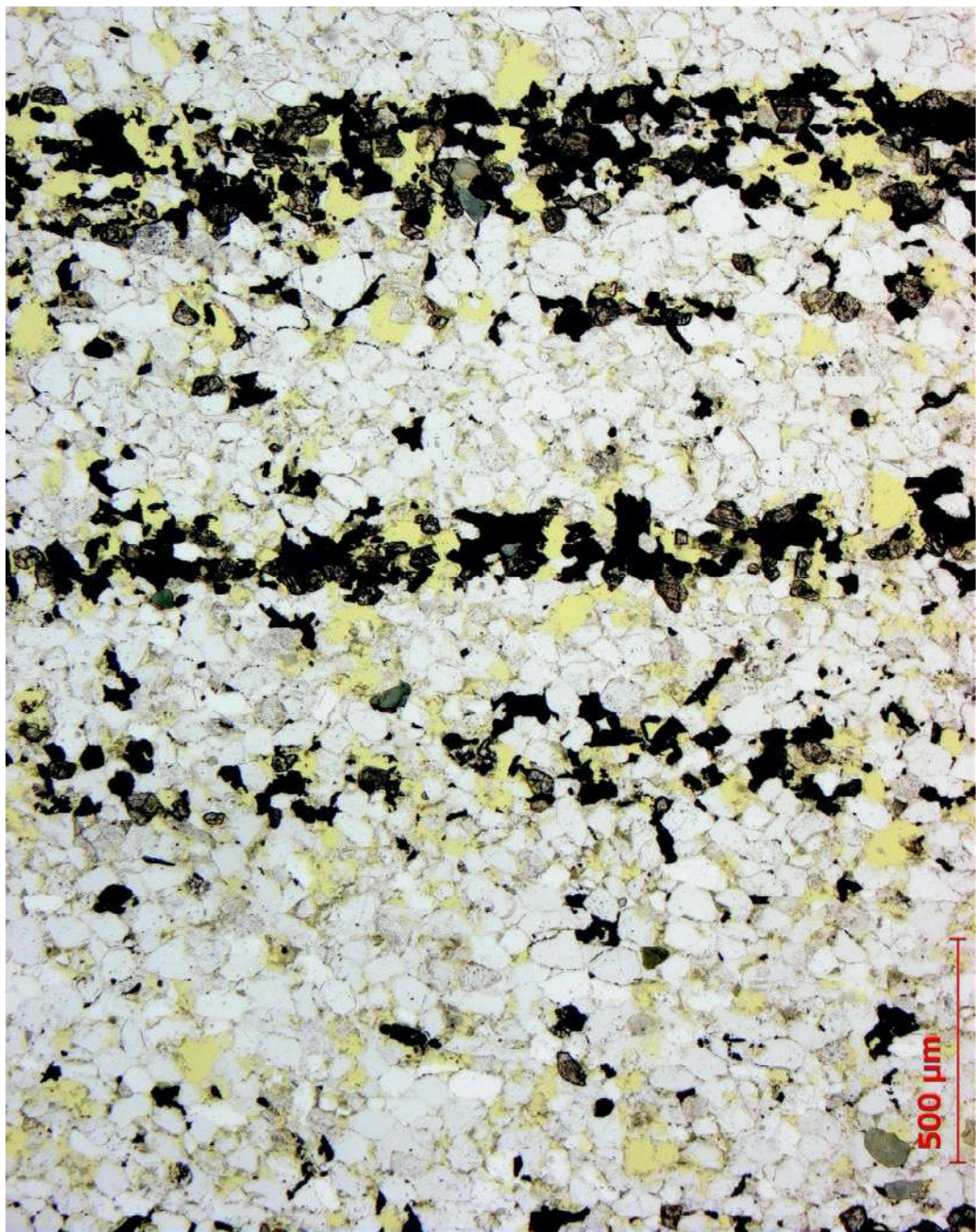
FIG. 103. Microscopische opname van een slijpplaatje van Indische zandsteen, met verticaal op elkaar volgende laagvormige concentraties van zware mineralen.
