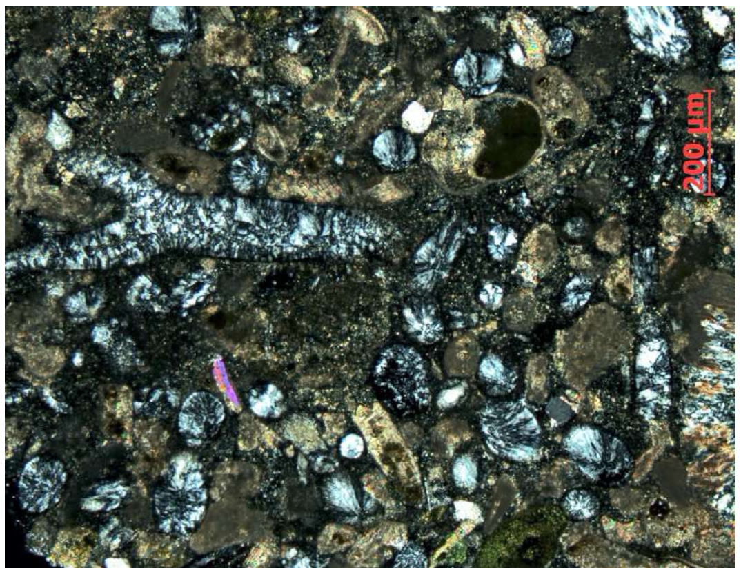
FIG. 111. Tufsteen van Lincent. Microscopische opname van een slijpplaatje (gepolariseerd licht met gekruiste polarisatoren).
