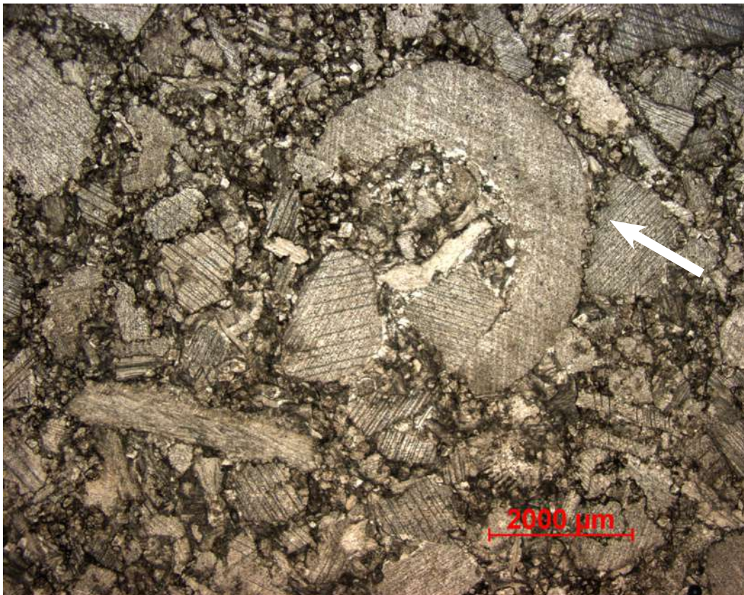
FIG. 62: Microscopische opname van een slijpplaatje van Petit Granit: let op de vele sutuurcontacten.
