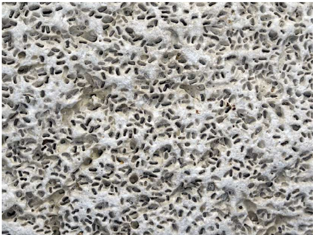
FIG. 76. Detail van het oppervlak van een door borstelwormen aangetaste kalksteen.
