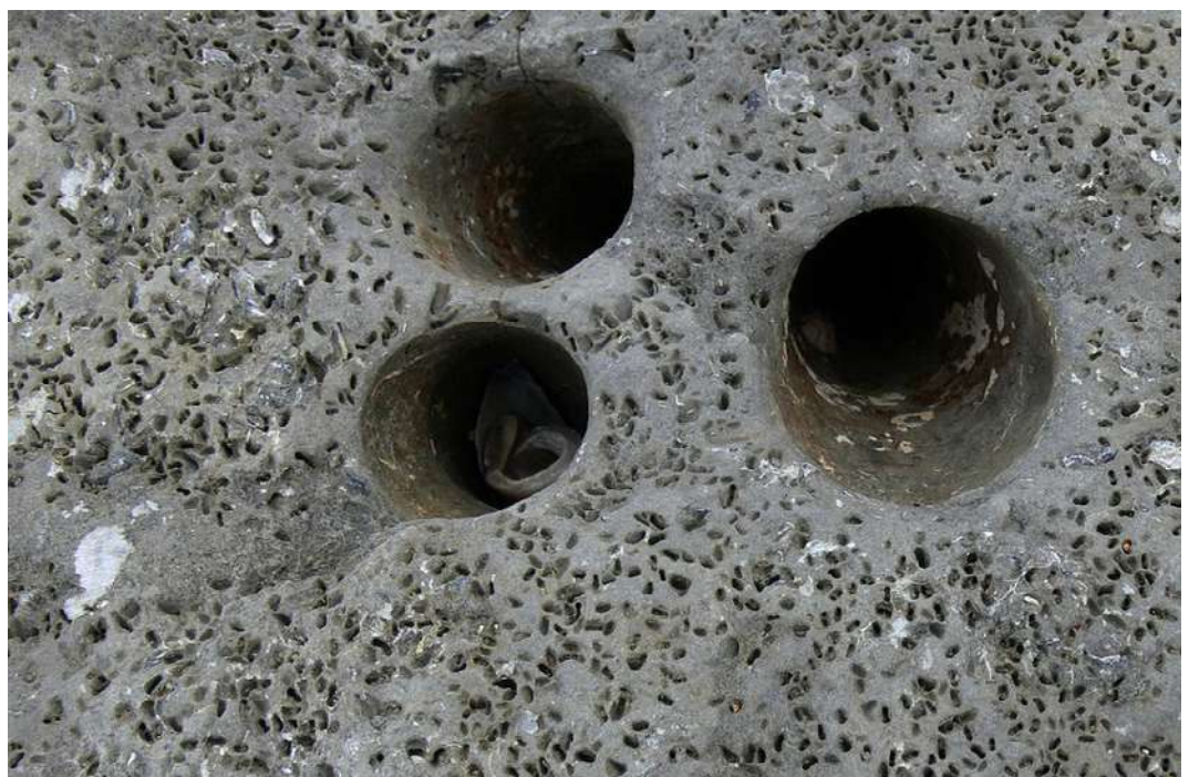
FIG. 75. Detail van een kalksteen doorboord met gaten van boormossels en kleinere gaatjes van borstelwormen.
