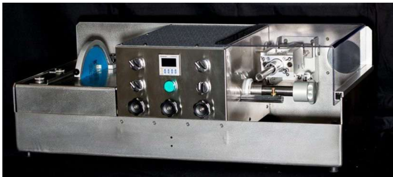
FIG. 3. Voorbeeld van automatische machine voor het maken van slijpplaatjes, bestaande uit een diamantzaag, waterkoelsysteem, vacuümpomp, vacuümsysteem om te snijden en te schuren en een set van hoge-precisie -schuurrollen met ingebed diamantpoeder (PELCON, Denemarken)
