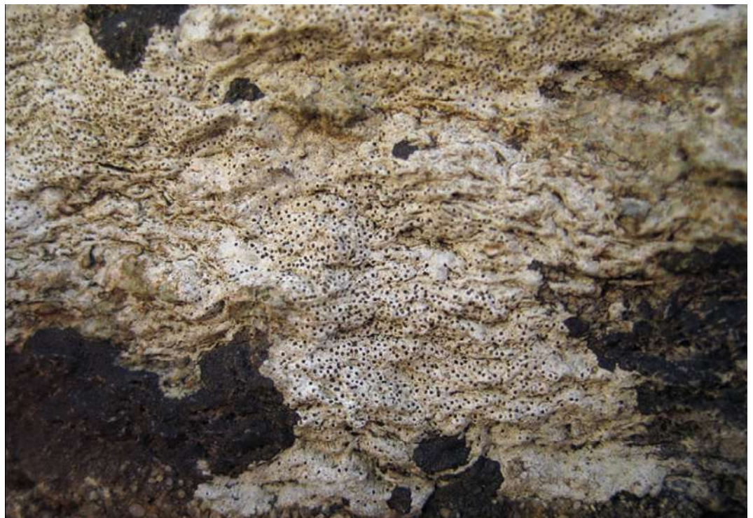
FIG. 37. Voorbeeld van "pitting": een door endolithische lichens geperforeerd kalksteenoppervlak (foto/ Jenny Seawright)
