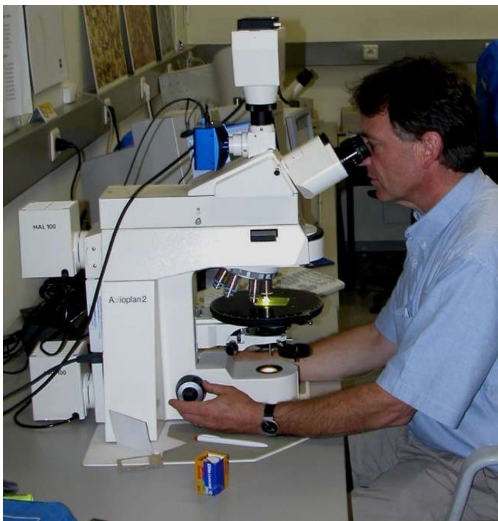
FIG. 123. Polarisatiemicroscop Axioplan-2 met digitale camera (Axiocam) – VITO, Mol
