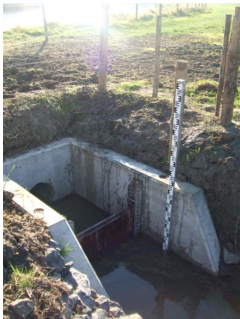
Situatie na plaatsing van peilschaal LMNS001X in de centrale afwateringsgracht naar de Leie
