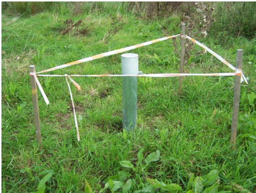
Situatie na herstel van de piëzometer en na herinstallatie van dezelfde diver
