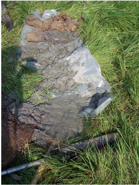
Bodemprofiel LMNP105X: zandige toplaag (bovenaan), daaronder de grijsrode ijzerhoudende kleilaag die op 1m10 diepte overgaat in de kleiige grijze reductiehorizont
