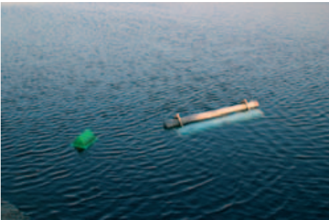
De twee voorbeeldbedrijven bestrijden algen in het water met ultrasone geluidsgolven.
