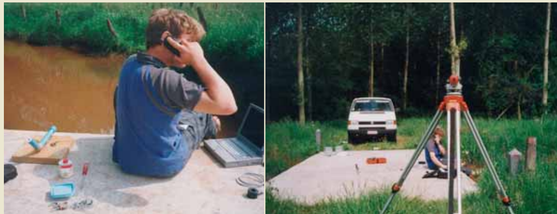
Een meetcampagne als toetsing van het model: peilmeters in het meest stroomafwaartse punt, afijking van het hydrologisch model en peilmeters op de te modelleren waterloop, afijking niet bemeeten deelstroomgebieden.
