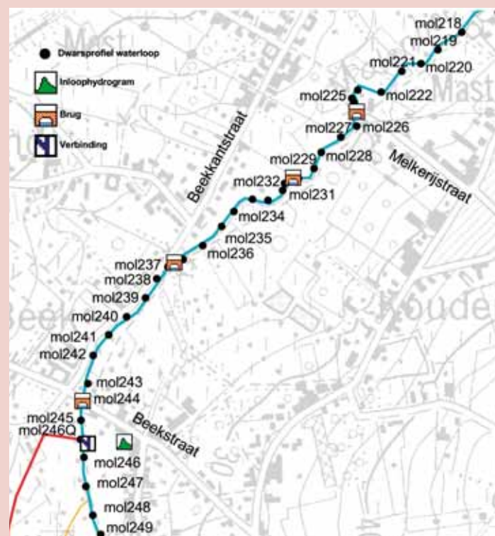
Schema van de knopen (rekenpunten) van het ISIS model ter hoogte van de dorpskern van Mere langs de Beekantstraat. Elke knoop wordt voorgesteld door een symbool dat de aard van de knoop illustreert. De zwarte bolletjes zijn de gewone dwarssecties van de waterlopen. Andere symbolen geven bijvoorbeeld een brug of een stuw weer.
