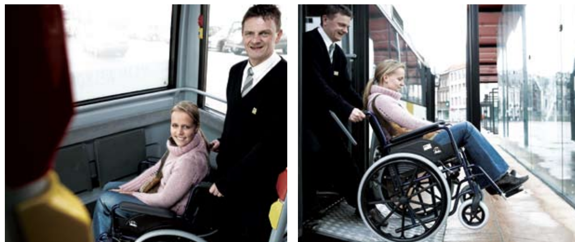
Een verankering en oprijdplaat verhogen het comfort en de veiligheid voor rolstoelgebruikers.
