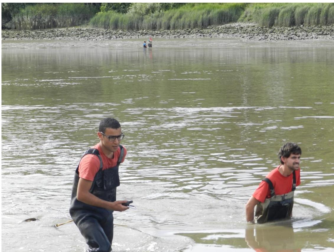
Foto 12: Bemonstering met bongonet van hyperbenthos voor het slik van Notelaer (voorgrond, ebgedomineerd) versus voor het slik van de Ballooi (achtergrond, vloedgedomineerd)
