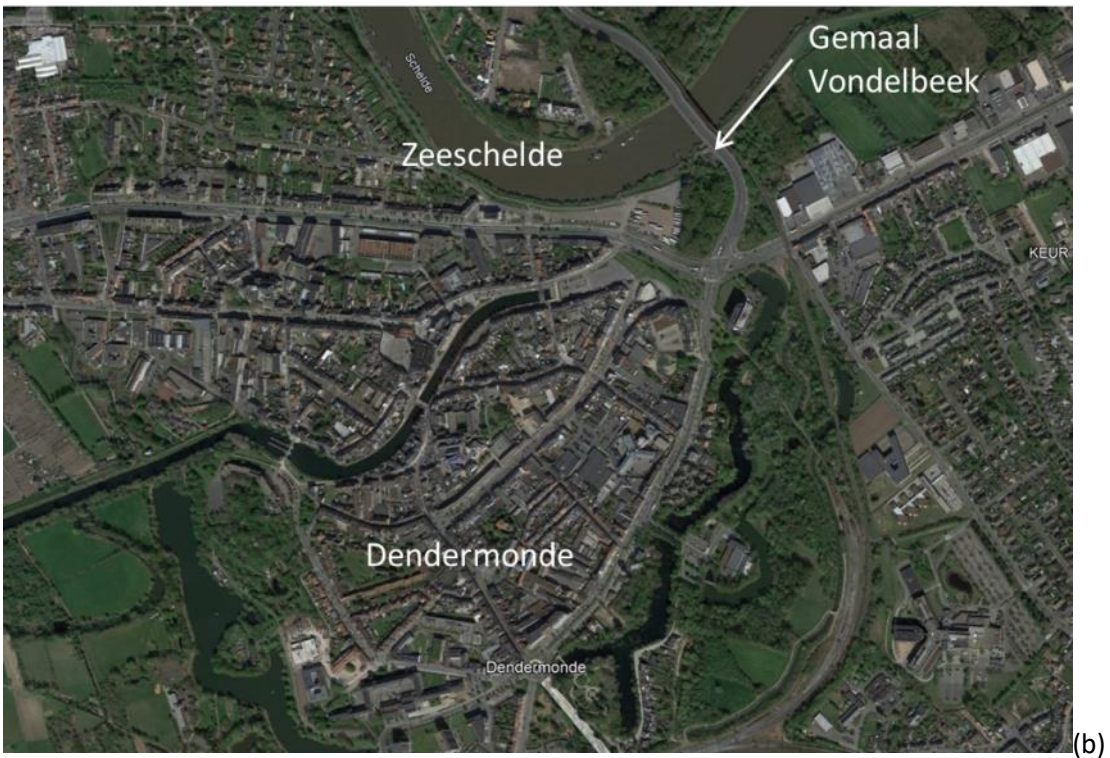
Figuur 44 Gemaal 'Vondelbeek' (a), en de ligging aan de monding van de Vondelbeek, naast de Zeeschelde (b). Wanneer water niet gravitair kan afwateren naar de Zeeschelde, wordt het overgepompt via dit gemaal. (Bron: Google StreetView (a) en Google Earth Pro (b)).
