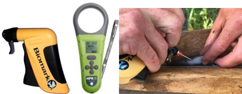
Figuur 63 (links) Schietpistool voor het inbrengen van de PIT-tag (Biomark); (midden) Reader voor aanwezige PIT-tags waar te nemen (Biomark); (rechts) inbrengen van PIT-tag met schietpistool.
