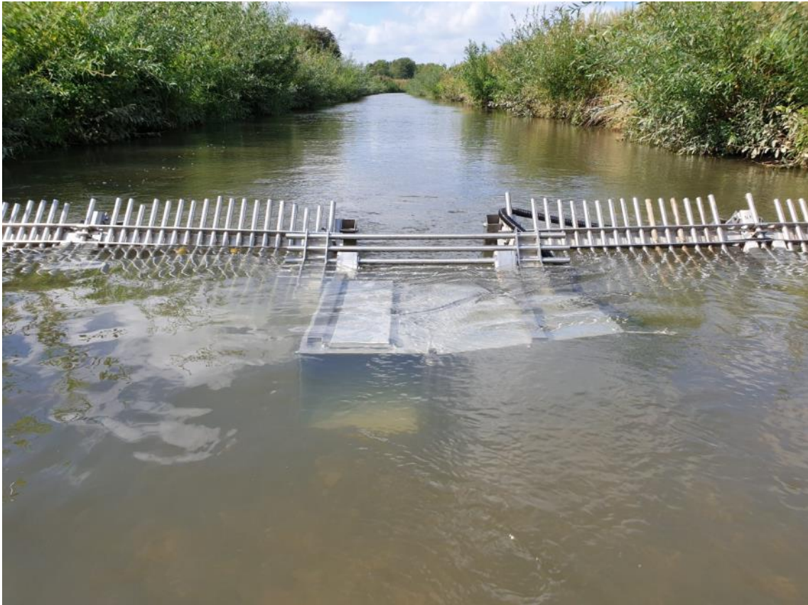
Figuur 136 Opstelling van het KB-TS camerasysteem in de Geul (NI) met visgeleidingsroosters.(bron: kb-ts.nl)
