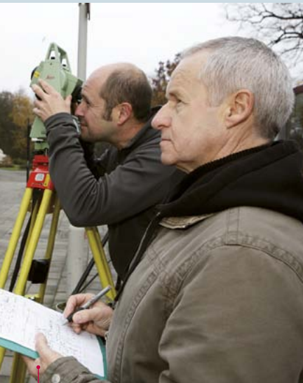
11:12 Landmeter Yves meet. Hij richt op de genummerde targets die ze hebben opgehangen. Willy noteert de nummers op een schets.
