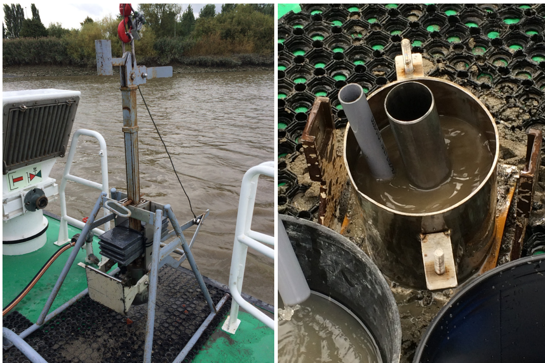
Figuur 3 – Boxcorer (links) en steekbuizen voor subsampling (rechts)
