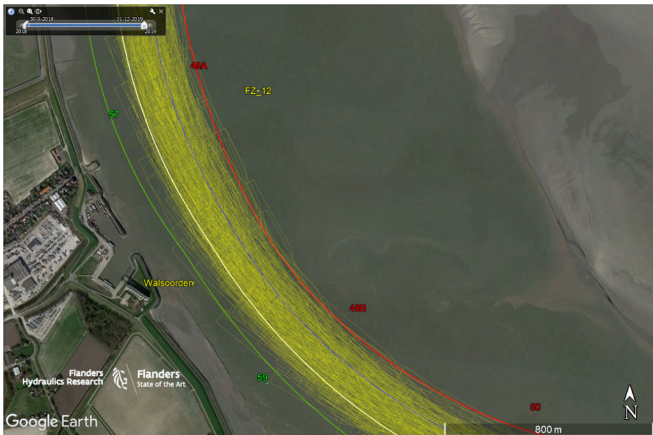
Figuur 7 – Vergelijking van referentietraject opvaart (wit) met AIS-trajecten van opvarende ULCS (geel)
