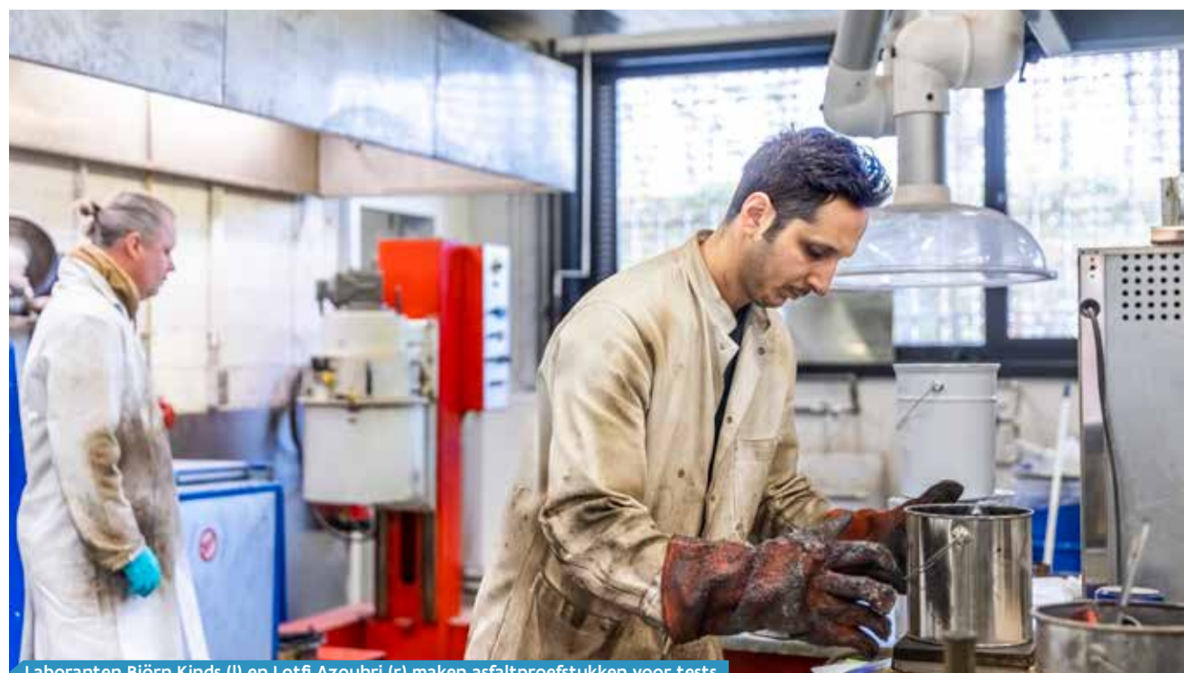
Laboranten Björn Kinds (l) en Lotfi Azouhri (r) maken asfaltproefstukken voor tests.
