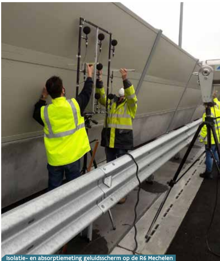
Isolatie- en absorptiemeting geluidsscherm op de R6 Mechelen
