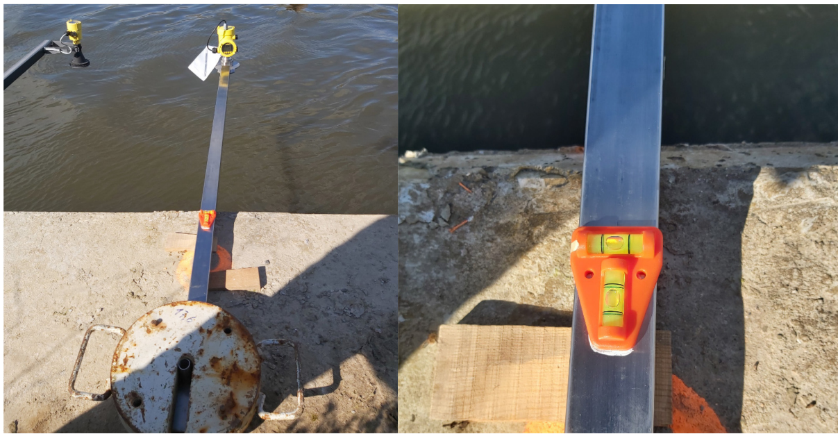
Figuur 7 – Mobiele radarpeilmeter waterpas gemonteerd naast afwaartse peilmeter nieuwe stuw Kerkhove
