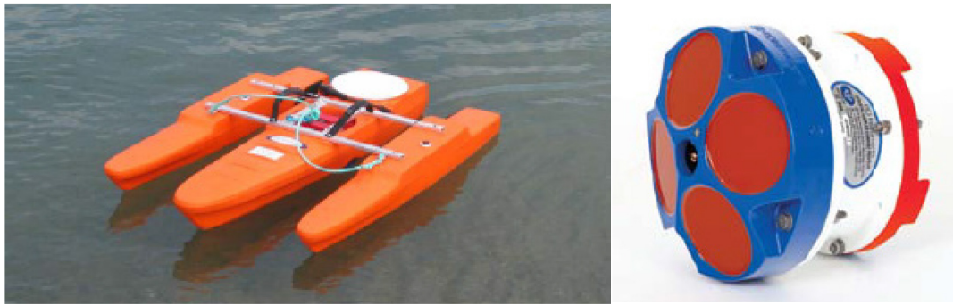
Figuur 4 – Trimaran met Riogrande 1200 kHz ADCP
