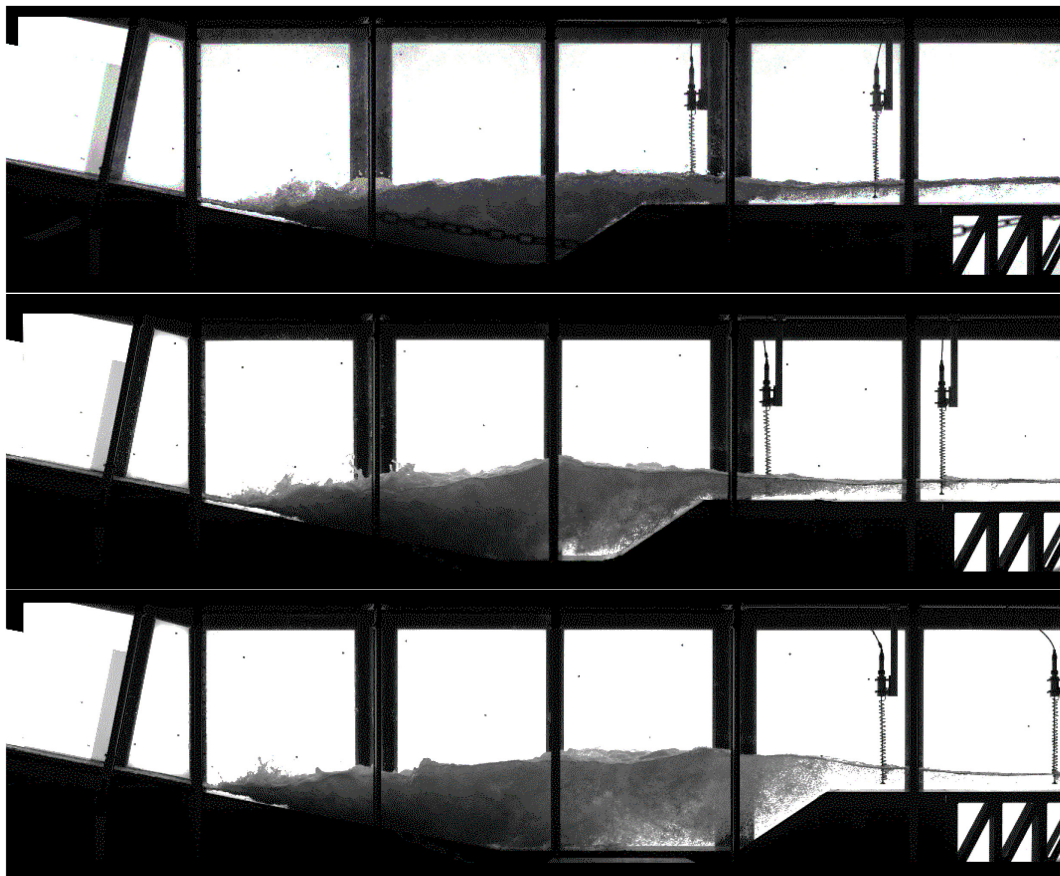
Grachtdiepte 0.50 m; Breedte dissipatiegracht: 0.50 m (boven)/ 1.0 m (midden)/ 2.0 m (onder)
