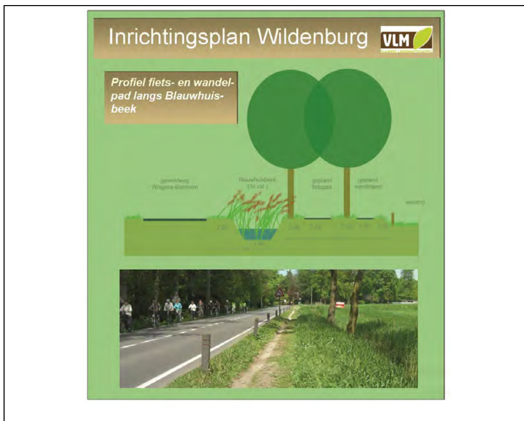
Figuur 20: Doorsnede fiets- en wandelpad langs de Blauwhuisbeek
