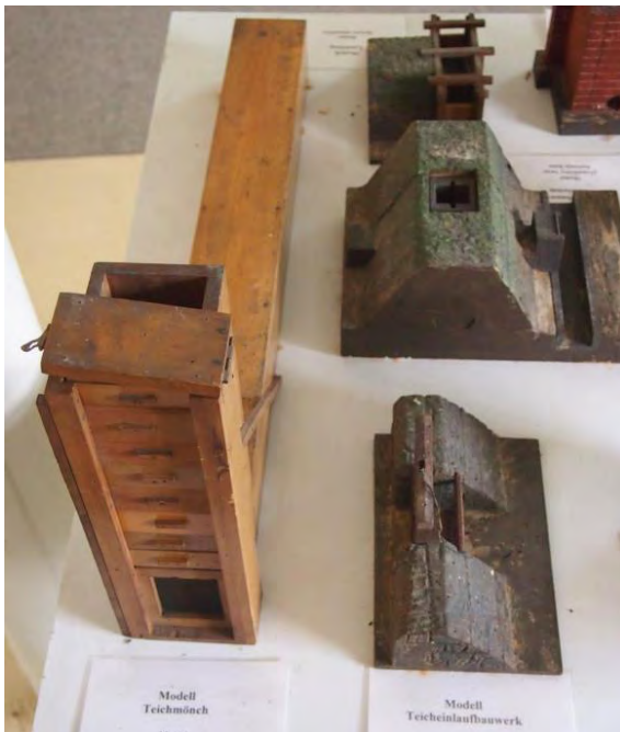
Foto 7 en 8: Diverse schaalmodellen van waterafvoerconstructies, "Informationszentrum Sächsische Teichwirtschaft" (foto Frank Debeil, 2015).
