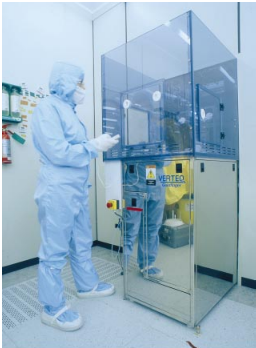
Verteq Goldfinger: dient voor de cleanstap na Cu CMP
