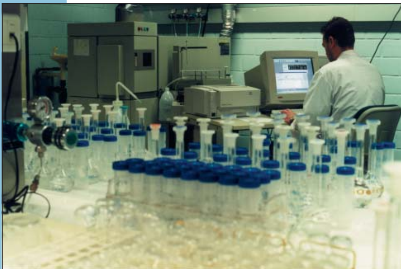
Analyse van zware metalen in milieumonsters met ICP-AES. Met specifieke detectiemethoden spoort Vito zware metalen en andere vervuilende stoffen op in milieumonsters. (foto Vito)
