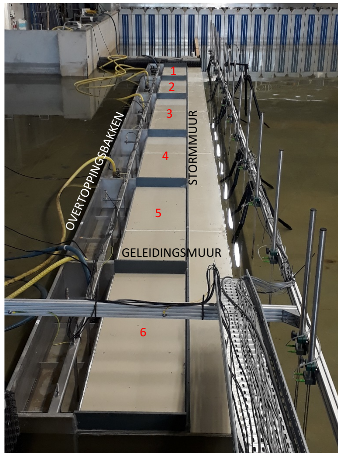
Figuur 6 – Stormmuur op het kaaivlak en overtoppingsbakken achter de kaaimuur.
