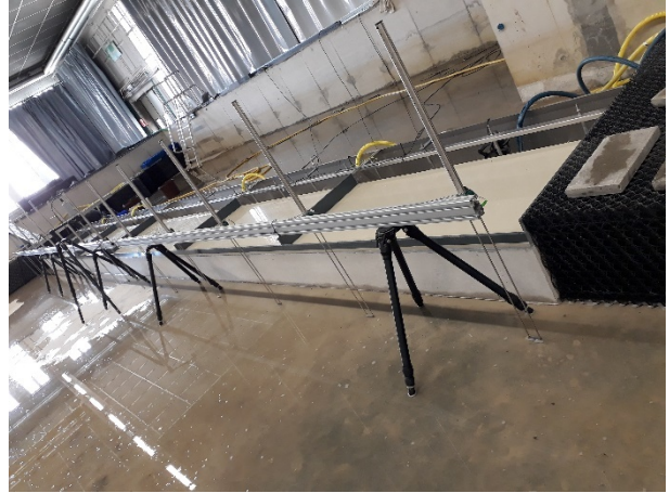
Figuur 4 – Foto's van het schaalmodel in de golftank
