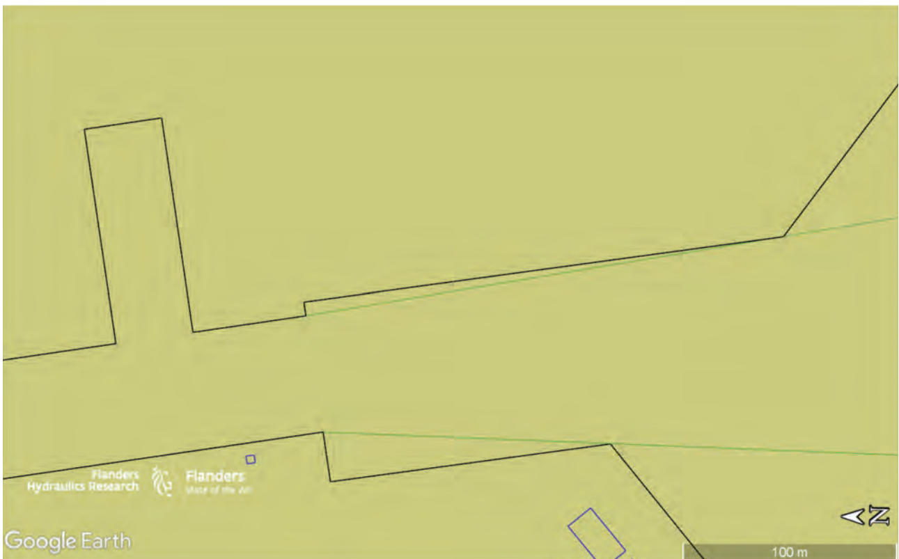
Figuur 12 – Variant A (Achterhaven): detail voorhaven van de sluis met weergave openingshoeken
