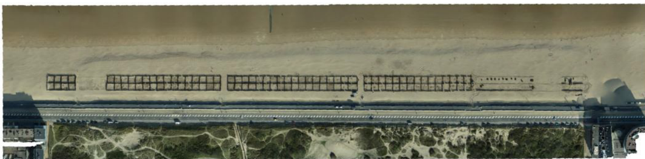
Figuur 4 – Orthofoto op het einde van de aanleg van de duin voor dijk pilot te Raversijde-Mariakerke (31/3/2021). Nog niet alle rijshouthagen en helm zijn geplaatst.
