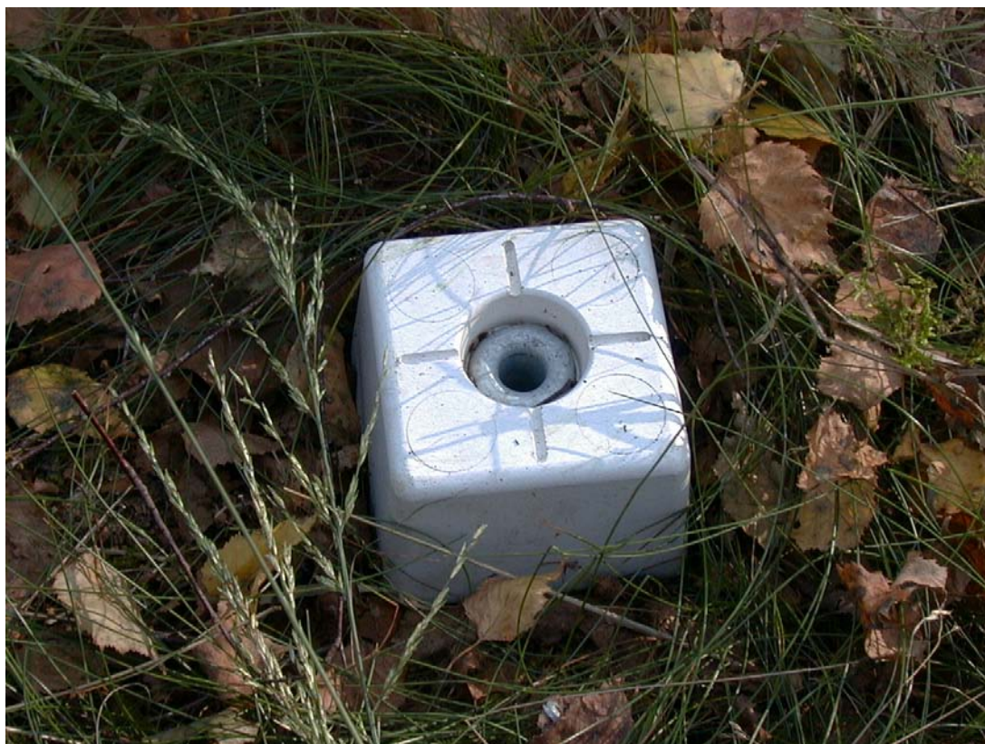
Figuur 3.1: Een fenopaal, die gebruikt wordt om de hoekpunten van de kernvlakte en het middelpunt van de cirkelplots permanent te markeren (foto: Bruno De Vos).
