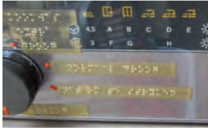
Knoppen waar op een eenvoudige manier een tactiele aanduiding en braille op aangebracht is.
