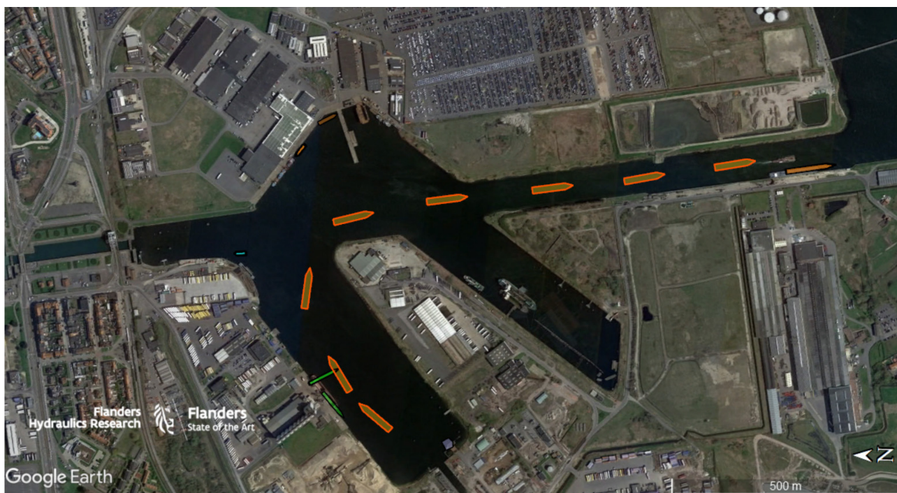
Figuur 14 – Verkeersbeeld scheepspassage middelgroot baggervaartuig (L 90 m) aan vaarsnelheid 7.6 kn (plotinterval 60 s)
