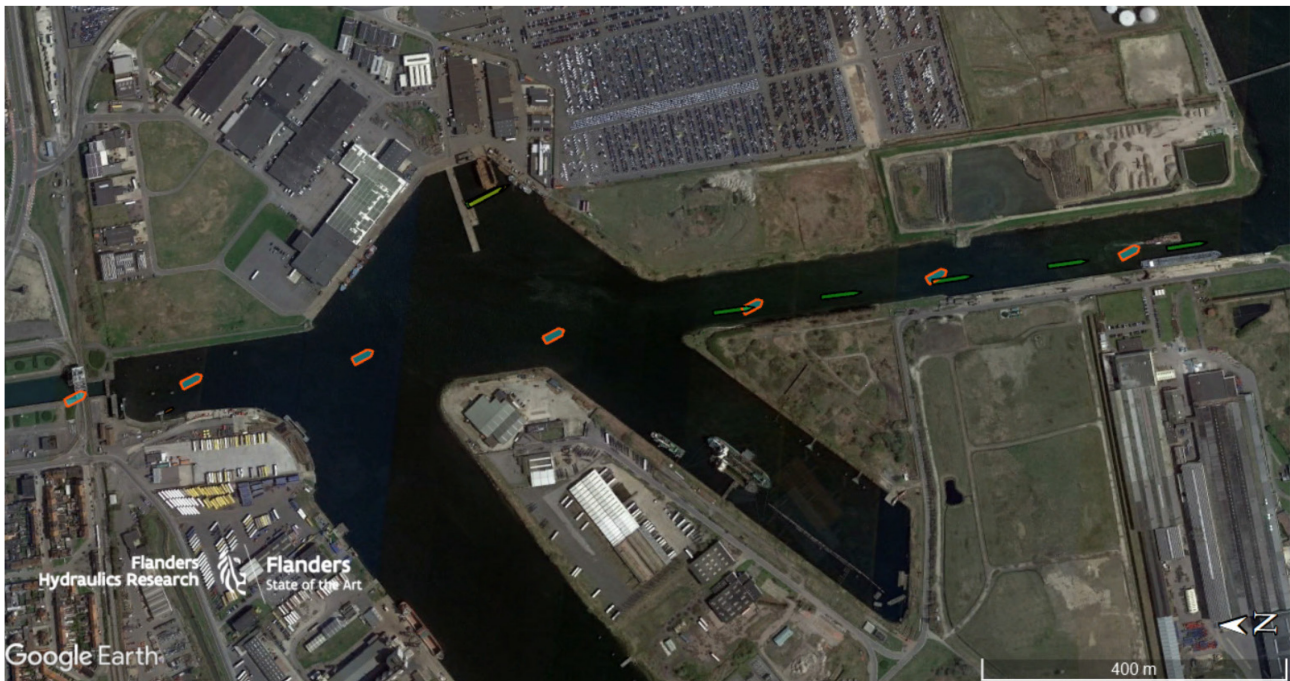
Figuur 11 – Verkeersbeeld scheepspassage groot sleepvaartuig 2 (L>30 m) aan vaarsnelheid 8.6 kn (plotinterval 60 s)
