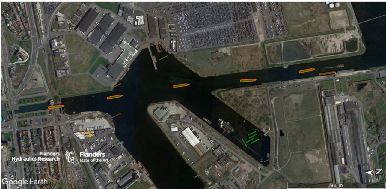
Figuur 6 – Verkeersbeeld scheepspassage binnenvaartschip (81 m x 9.5 m) aan vaarsnelheid 11.0 kn (plotinterval 60 s)
