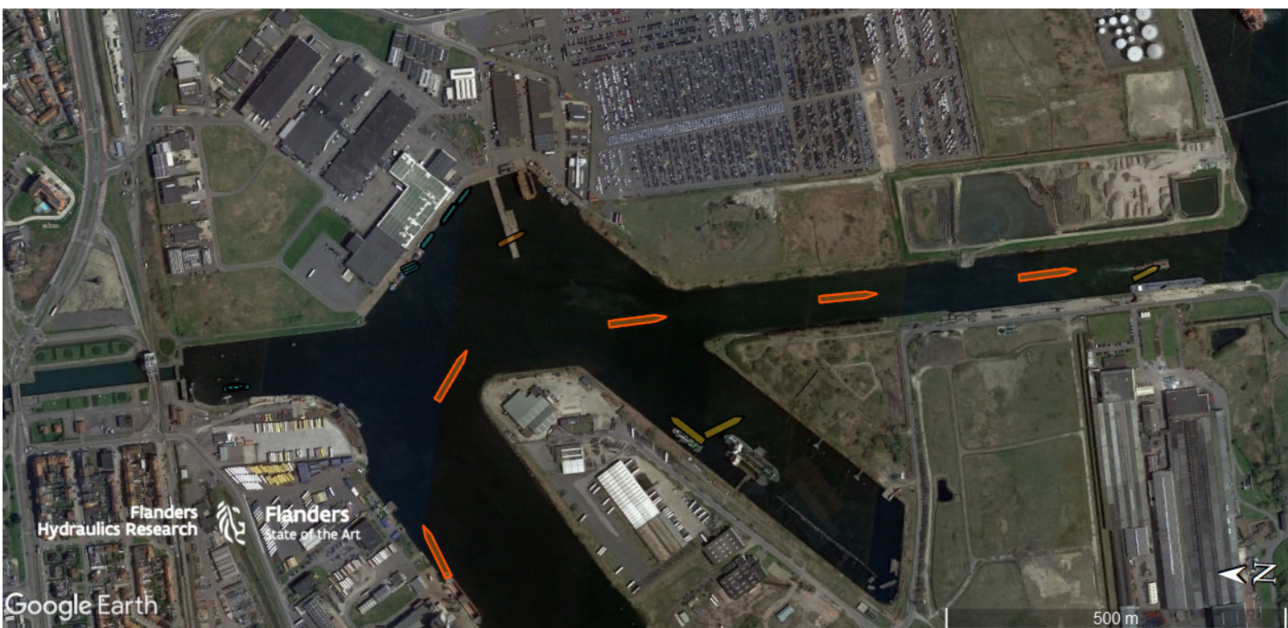
Figuur 7 – Verkeersbeeld scheepspassage binnenvaartschip (85 m x 9.5 m) aan vaarsnelheid 10.0 kn (plotinterval 60 s)
