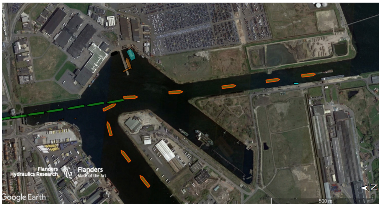
Figuur 13 – Verkeersbeeld scheepspassage klein baggervaartuig (L 65 m) aan vaarsnelheid 7.9 kn (plotinterval 60 s)
