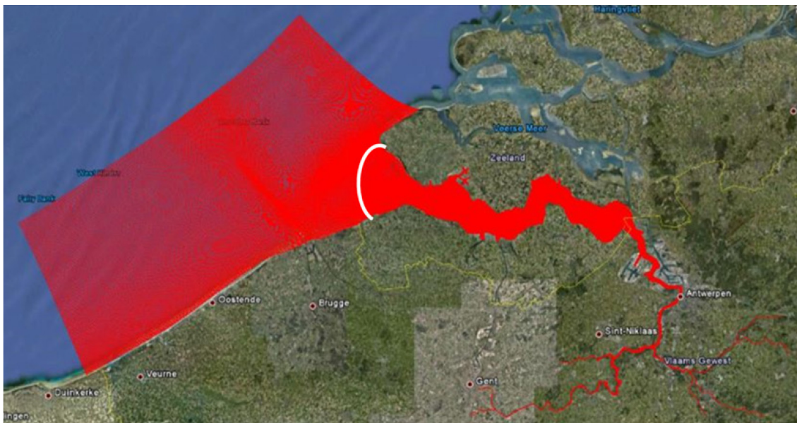
Figuur 11 – Illustratie van het Delft3D-NeVla rooster met locatie van de afgeknipte rand bij Westkapelle-Cadzand (witte lijn).
