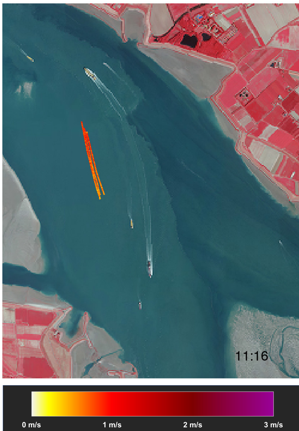
Figuur 8 – Overzicht stroompatronen voor loslaatmoment 1 tijdens eerste meetdag Tijdstip [MEZT] onderaan rechts is het moment van te water lating van de vlotters
