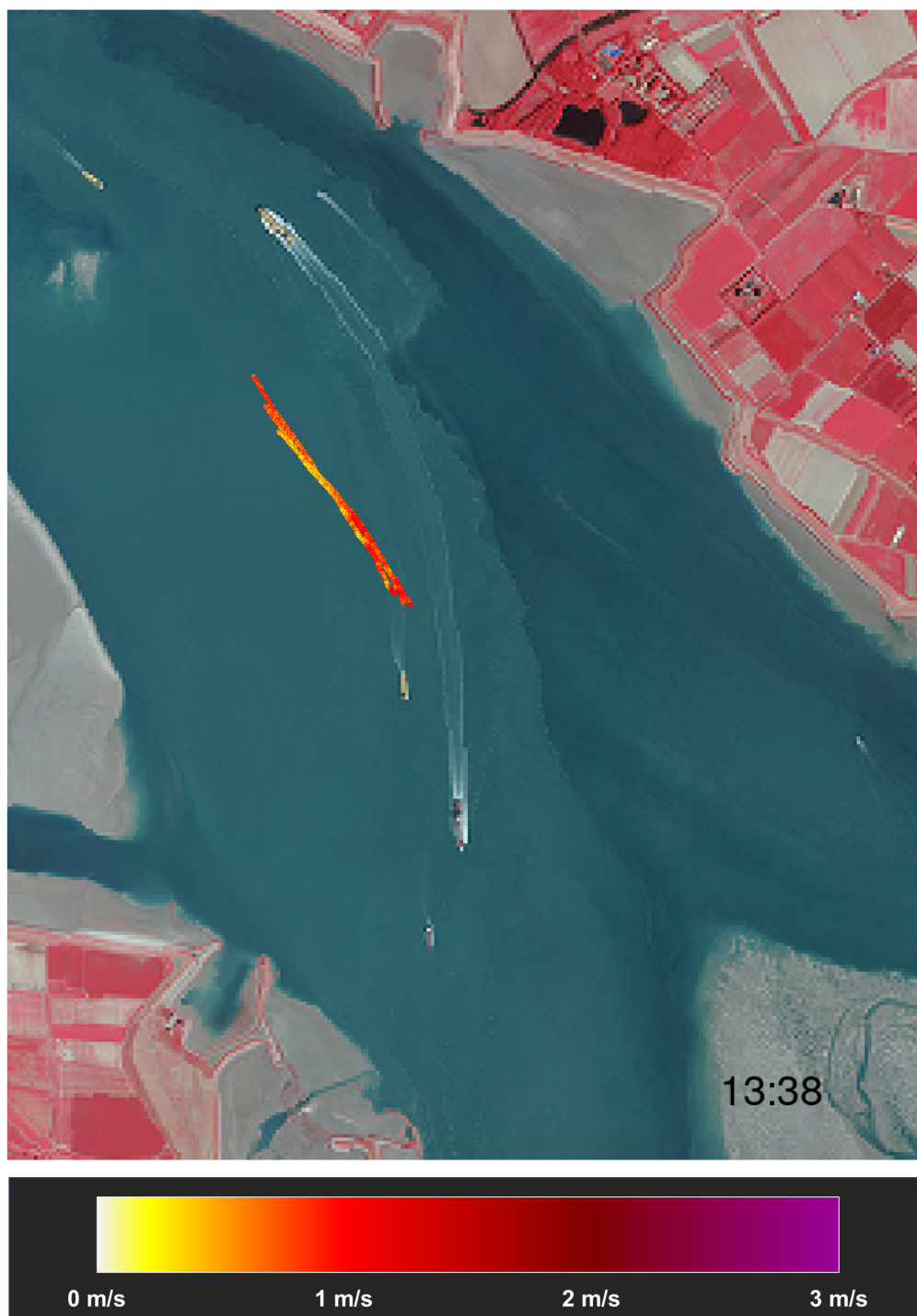
Figuur 12 – Overzicht stroompatronen voor loslaatmoment 5 tijdens eerste meetdag Tijdstip [MEZT] onderaan rechts is het moment van te water lating van de vlotters
