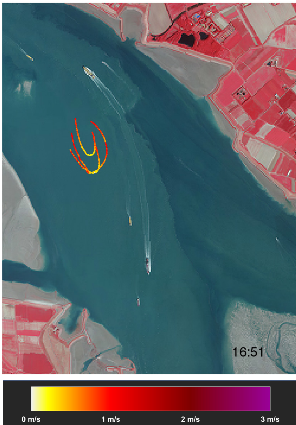
Figuur 25 – Overzicht stroompatronen voor loslaatmoment 9 tijdens tweede meetdag Tijdstip [MEZT] onderaan rechts is het moment van te water lating van de vlotters
