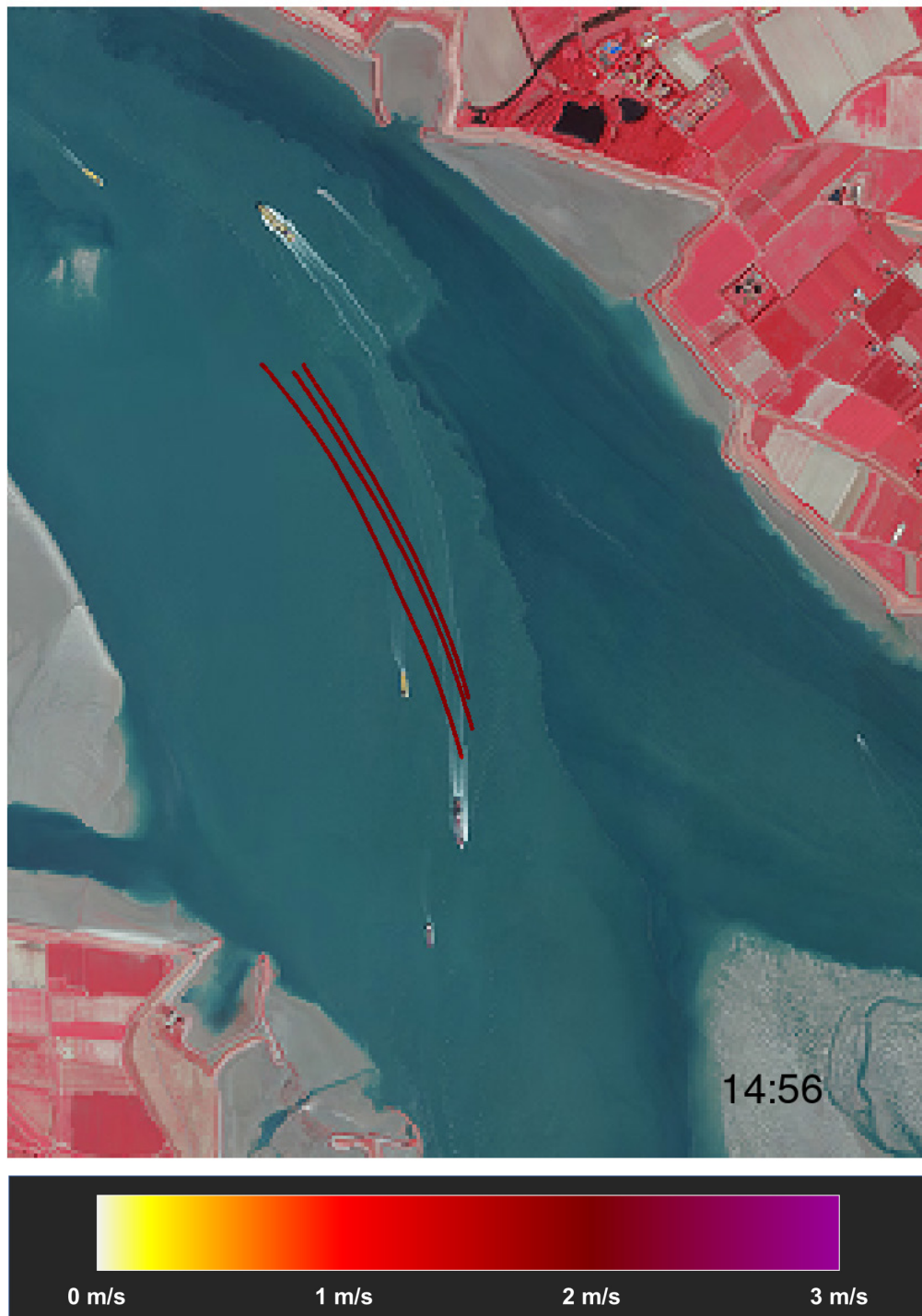
Figuur 14 – Overzicht stroompatronen voor loslaatmoment 7 tijdens eerste meetdag Tijdstip [MEZT] onderaan rechts is het moment van te water lating van de vlotters
