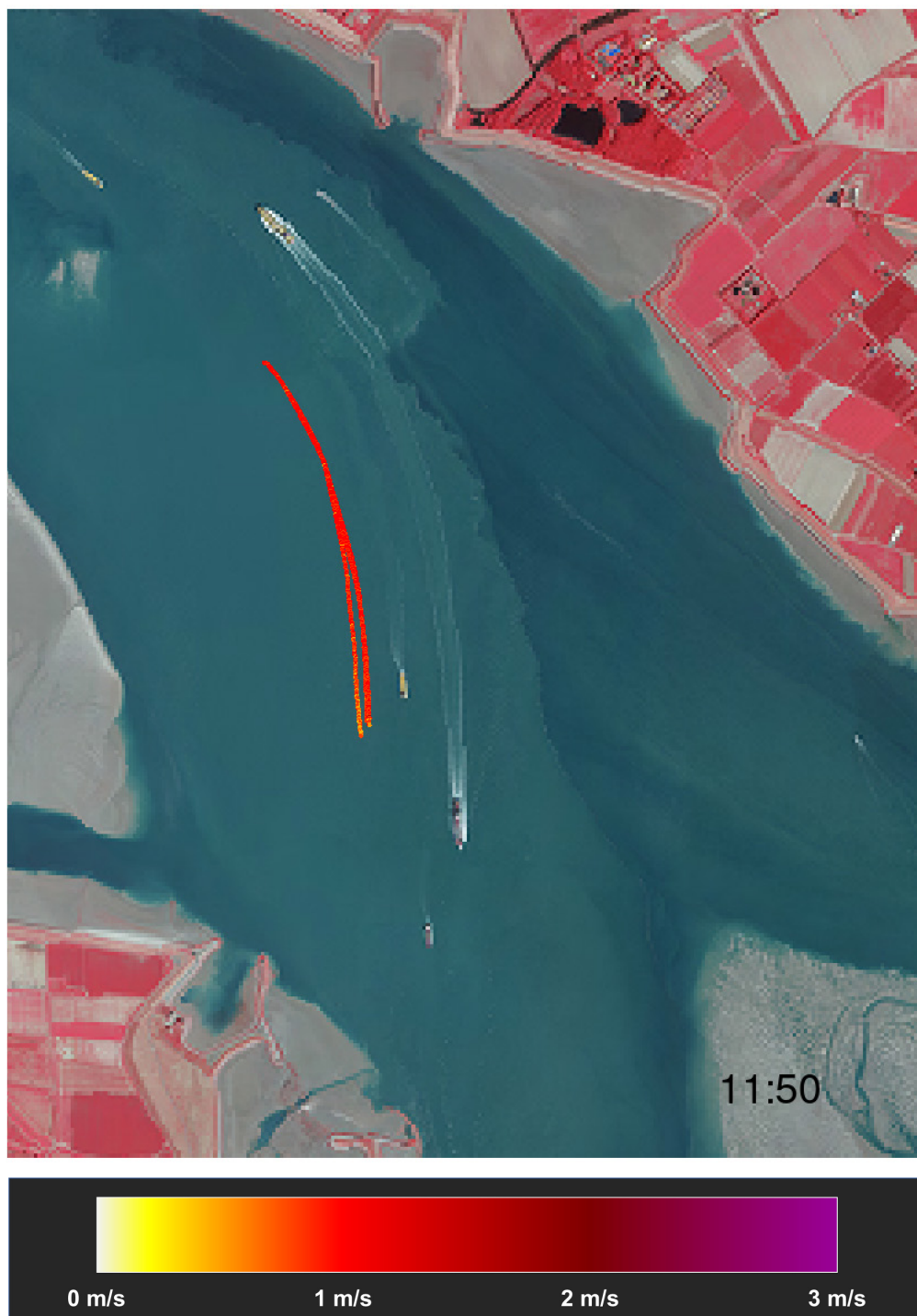
Figuur 9 – Overzicht stroompatronen voor loslaatmoment 2 tijdens eerste meetdag Tijdstip [MEZT] onderaan rechts is het moment van te water lating van de vlotters
