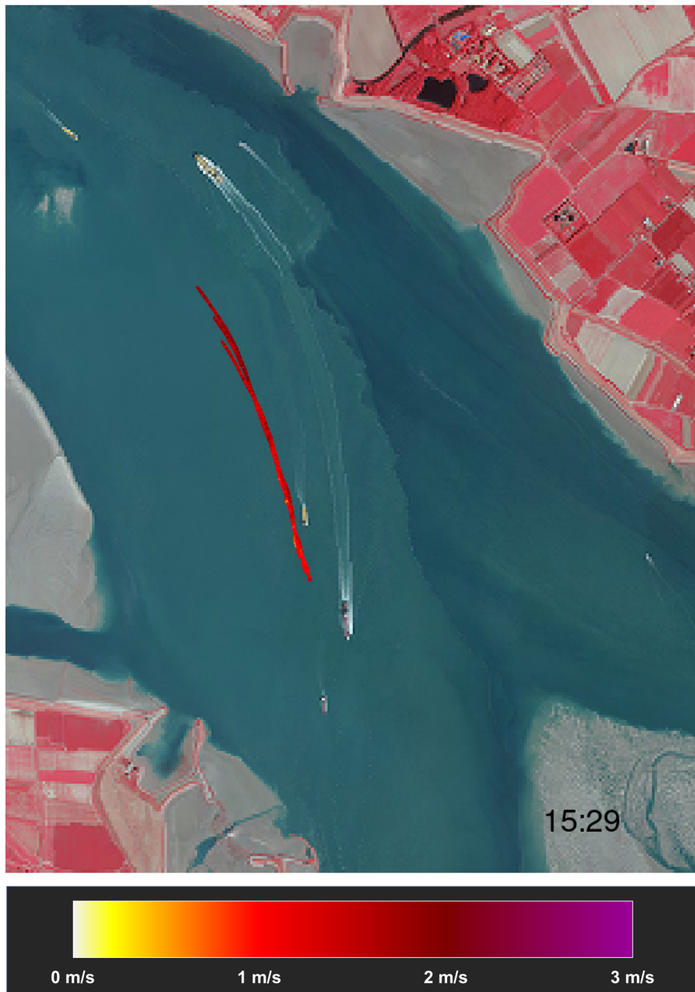
Figuur 15 – Overzicht stroompatronen voor loslaatmoment 8 tijdens eerste meetdag Tijdstip [MEZT] onderaan rechts is het moment van te water lating van de vlotters
