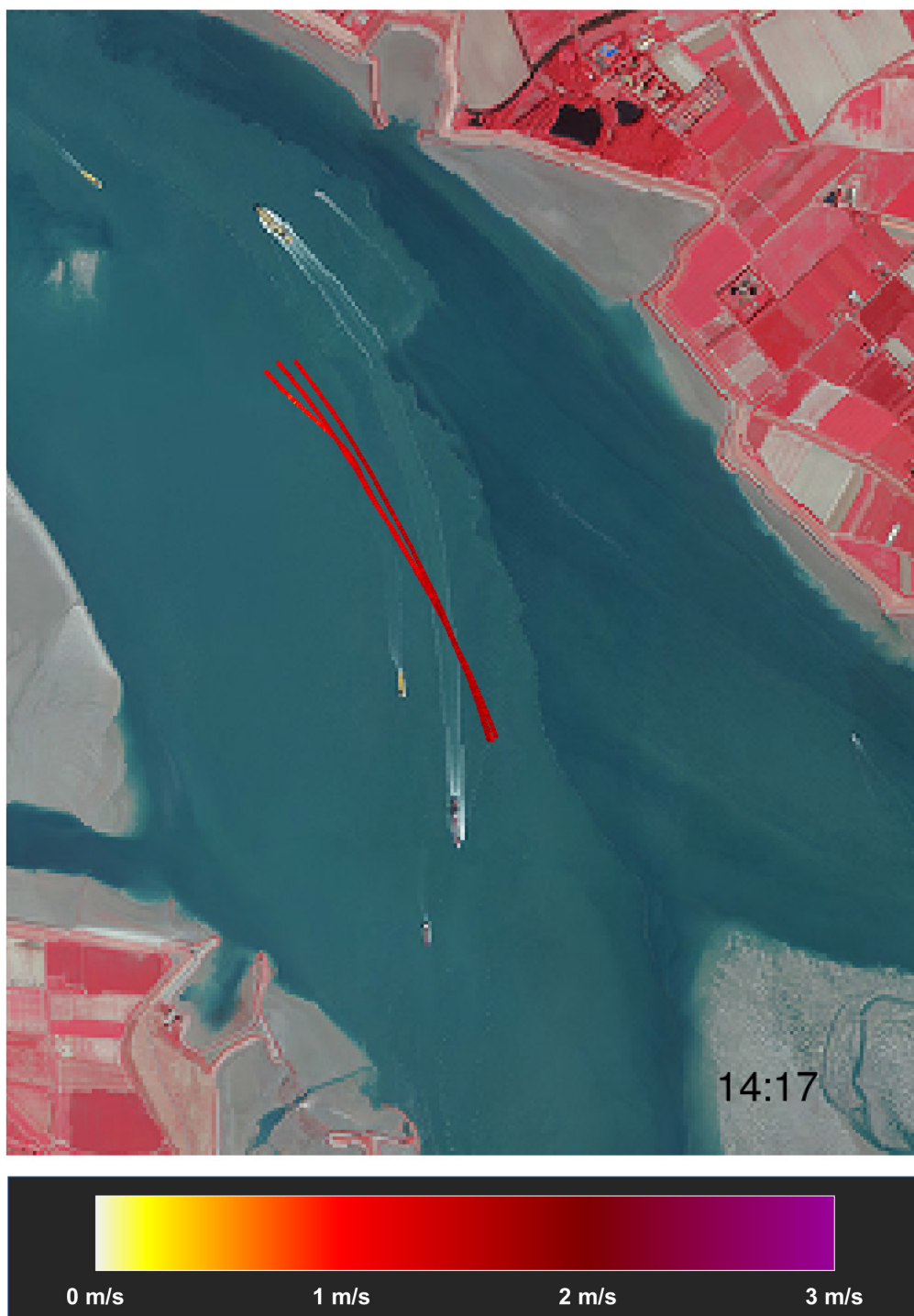
Figuur 13 – Overzicht stroompatronen voor loslaatmoment 6 tijdens eerste meetdag Tijdstip [MEZT] onderaan rechts is het moment van te water lating van de vlotters
