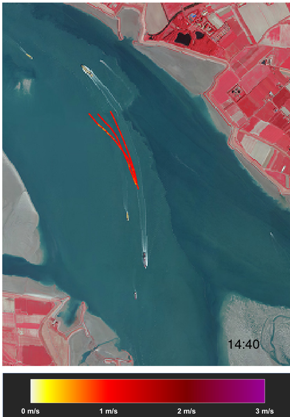
Figuur 21 – Overzicht stroompatronen voor loslaatmoment 5 tijdens tweede meetdag Tijdstip [MEZT] onderaan rechts is het moment van te water lating van de vlotter
