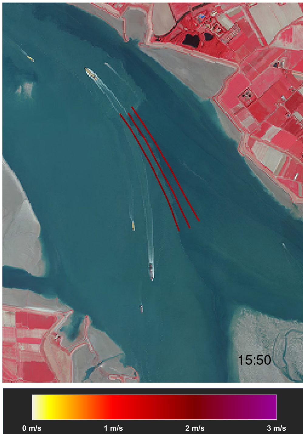
Figuur 23 – Overzicht stroompatronen voor loslaatmoment 7 tijdens tweede meetdag Tijdstip [MEZT] onderaan rechts is het moment van te water lating van de vlotters
