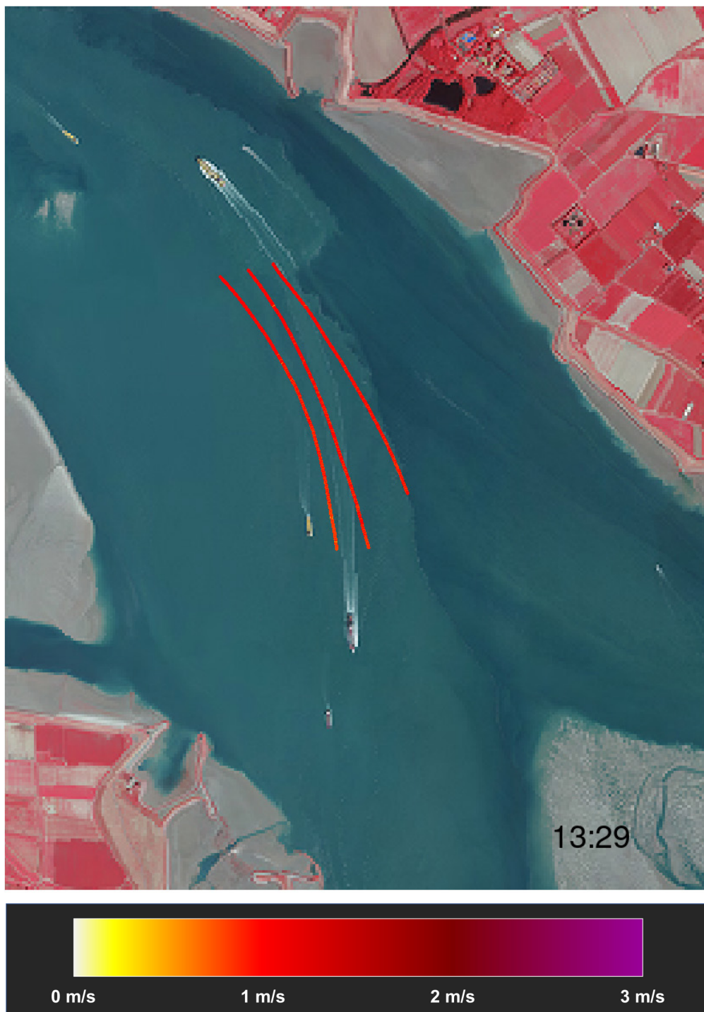
Figuur 19 – Overzicht stroompatronen voor loslaatmoment 3 tijdens tweede meetdag Tijdstip [MEZT] onderaan rechts is het moment van te water lating van de vlotters
