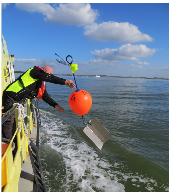
Figuur 3 – Uitgooien (links) en recupereren (rechts) van de vlotters vanaf het meetschip
