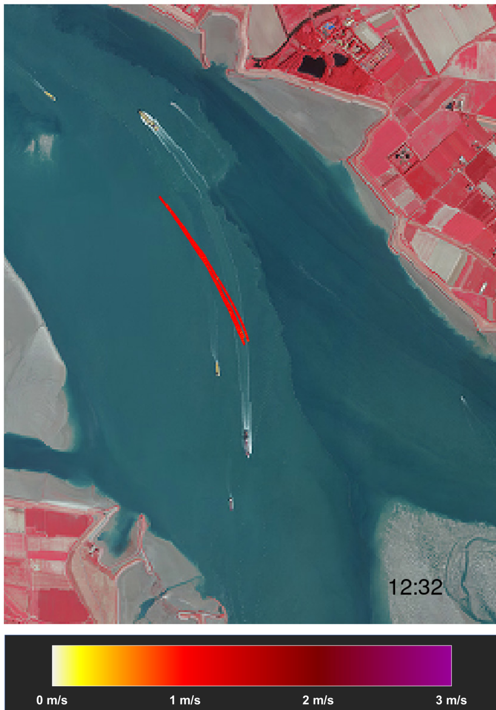
Figuur 10 – Overzicht stroompatronen voor loslaatmoment 3 tijdens eerste meetdag Tijdstip [MEZT] onderaan rechts is het moment van te water lating van de vlotters
