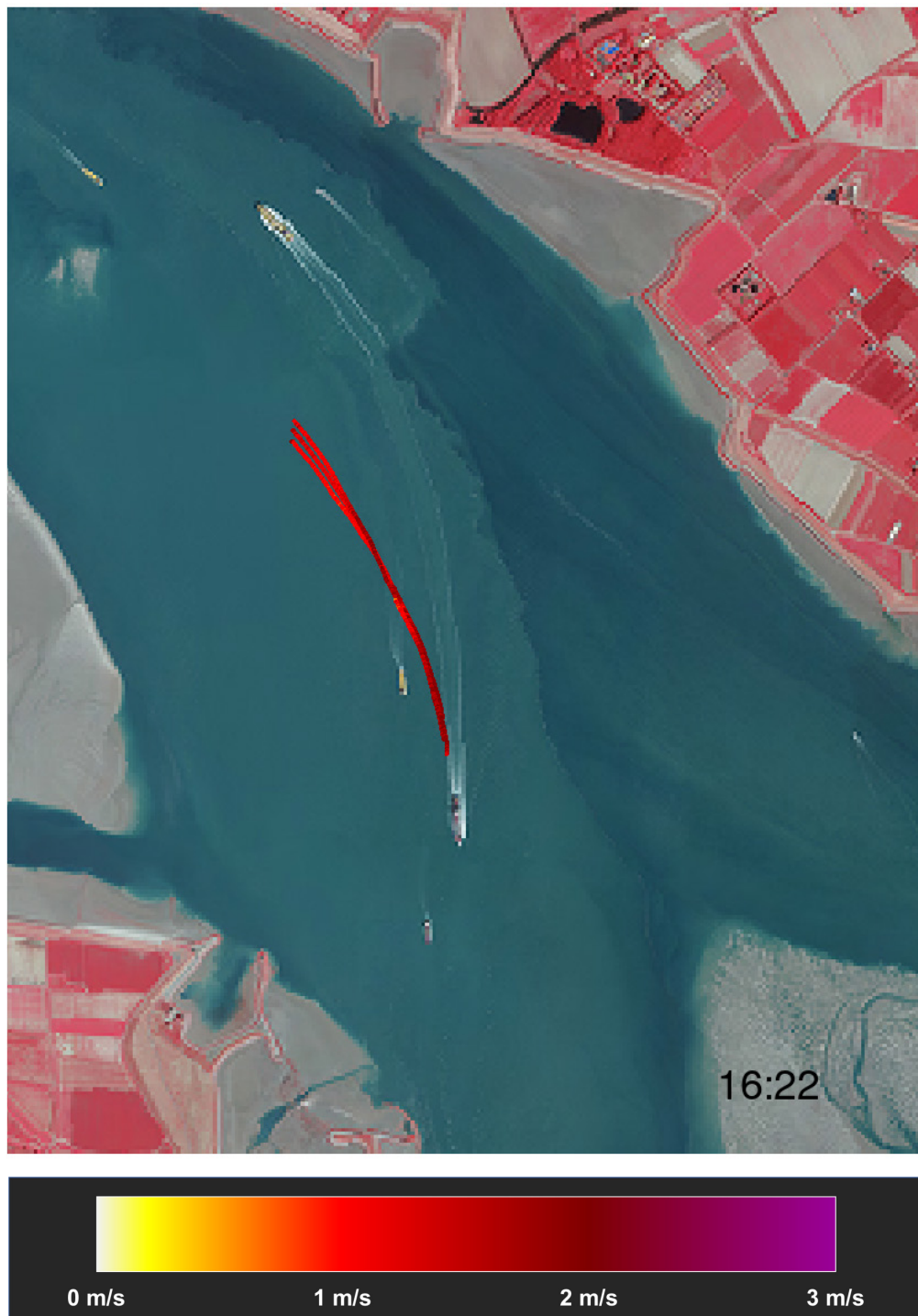
Figuur 24 – Overzicht stroompatronen voor loslaatmoment 8 tijdens tweede meetdag Tijdstip [MEZT] onderaan rechts is het moment van te water lating van de vlotters
