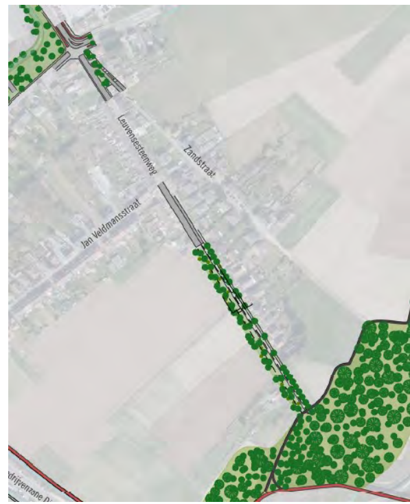
Figuur 15 ontwerp ontharding Leuvensesteenweg en heraanleg kruispunt
