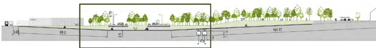
Figuur 8 Scenario fietstunnel onder Woluwelaan thv Catsite
