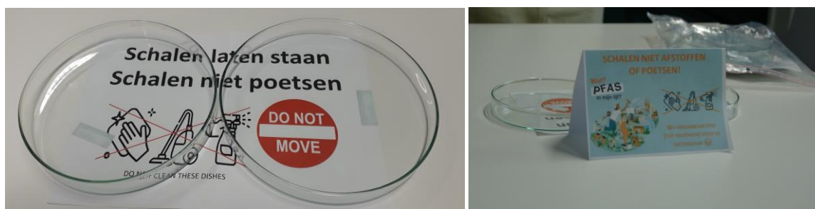
Figuur 2: Illustratie van de opstelling van de schalen voor bemonstering van huisstof.
