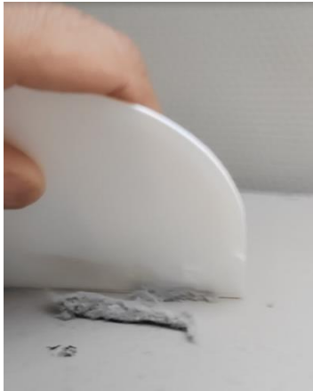
Figuur 3: Illustratie van de bemonstering van huisstof met de schraper.
