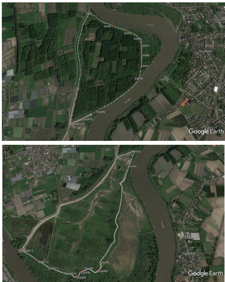
Grijze punten: punten gebruikt voor berekening van effectieve strijklengte Rode punten: punten waarin golfhoogte en piekperiode berekend zijn
