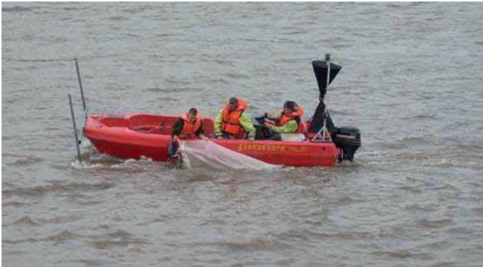
Fig. 13. Bemonstering m.b.v. de sleepnetten. De twee konische netten worden bevestigd aan het frame op de voorkant van de boot en worden langs beide zijden van de boot gesleept tegen de stroming in. De netten hangen op ongeveer 0.5 m diepte, zijn 2 m lang en hebben een opening van 0.5 m diameter.
