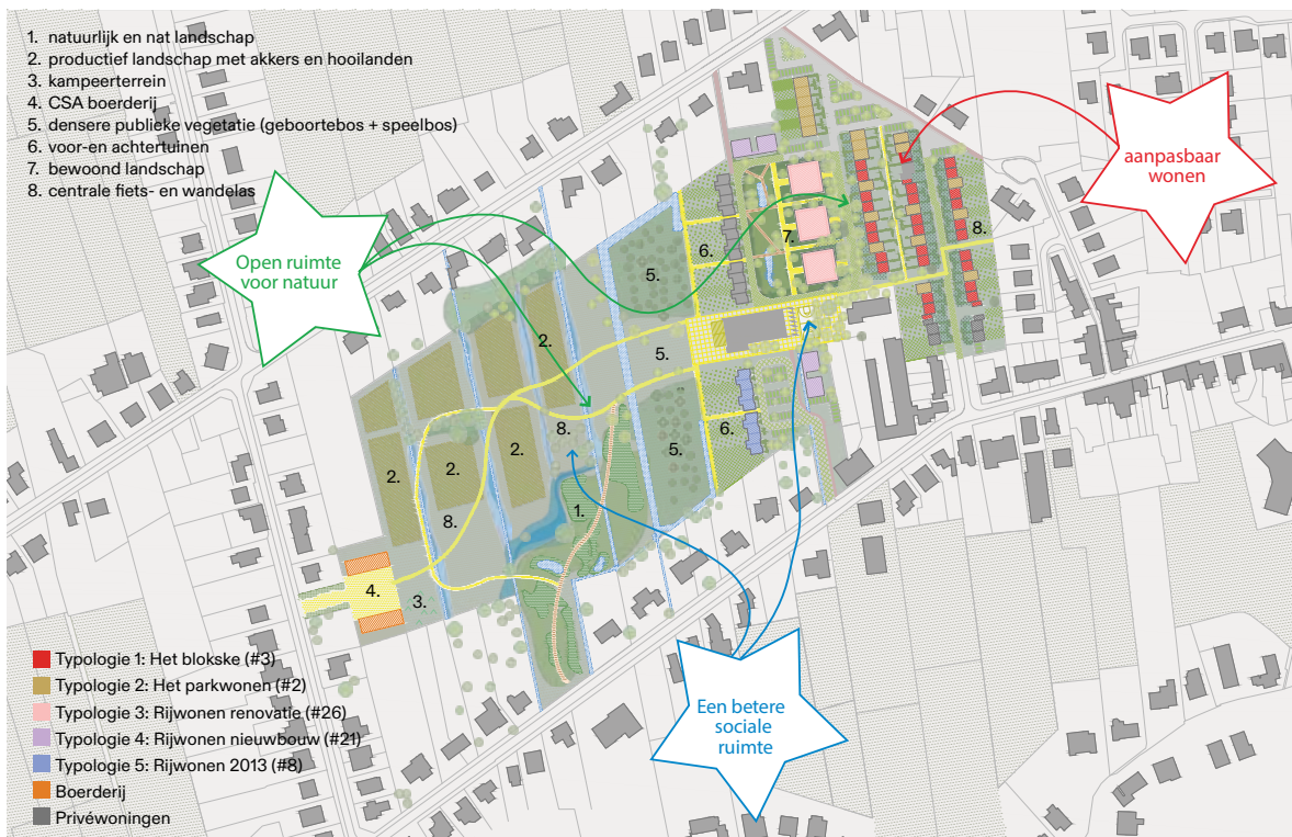
Overzichtsplan van de vernieuwde wijk. Links de heraangelegde polder met ruimte voor waterberging. Rechts de woonwijk met de verschillende nieuwe en vernieuwde woontypes. De straten zijn heringericht als een bruikbare leefruimte, naar het voorbeeld van de Kartoffelraekkerne in Kopenhagen.
