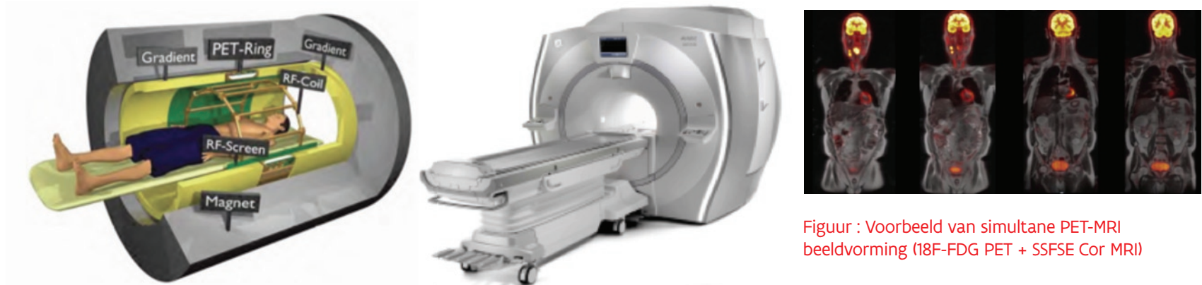
Figuur : Doorsnede en finaal uitzicht PET-MRI scanner met PET-ring in het magnetisch veld voor simultane beeldopnames.
