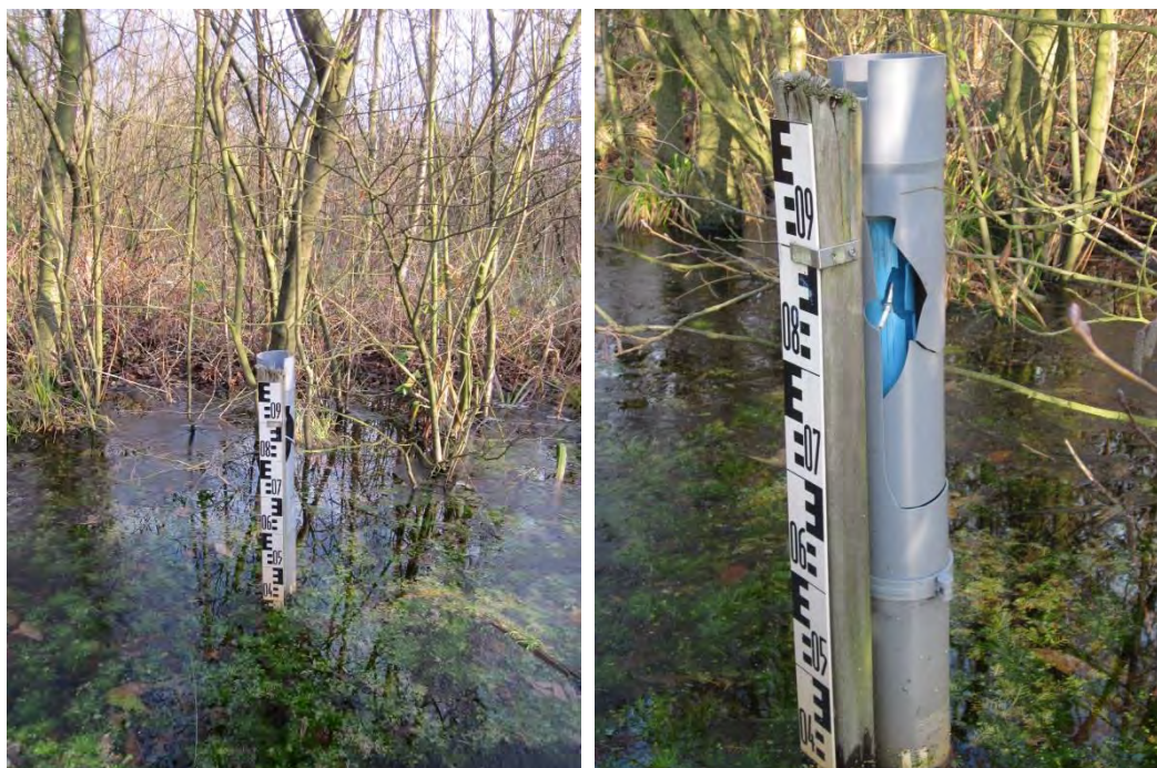
Figuur 2: Vastgestelde schade aan peilbuis STRS002X op 12/12/2012.
