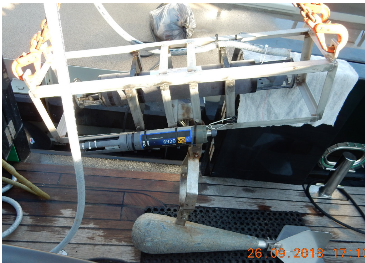
Figuur 3 – LISST-100X in meetframe met bevestiging pompdarm (rechts-boven) en YSI (links-onder)
