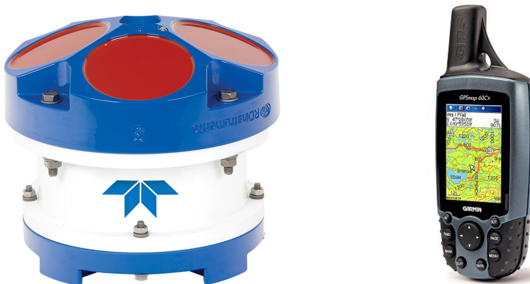
Figuur 4 – Gebruikte meettoestellen: ADCP RDI Workhorse Monitor (links) en Garmin GPS (rechts)
