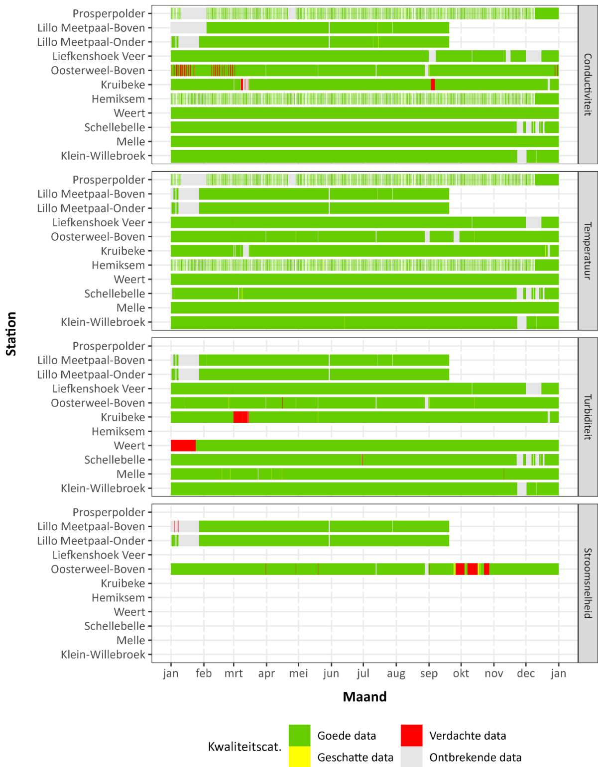
Figuur 30 – Overzicht van de datakwaliteit per parameter en per station voor de continue metingen fysische parameters (meetfrequentie 5 min) voor 2022. Voor Prosperpolder en Hemiksem is de frequentie van conductiviteit en temperatuur lager (10 min).
