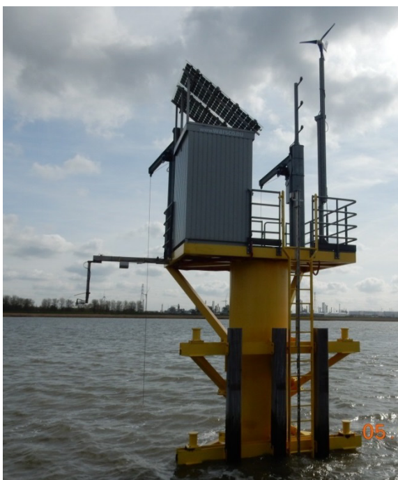
Figuur 71 – Locatie Lillo-Meetpaal met links-uitstekend arm van golvenmeter (links) en detail Log-aLevel toestel (rechts)
